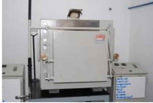
Figura 14 - Forno Tipo Mufla "Jung"
