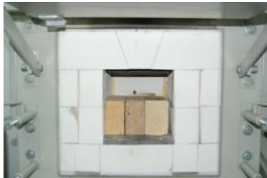
Figura 15 - Utilização de tijolos refratários nos tratamentos térmicos
