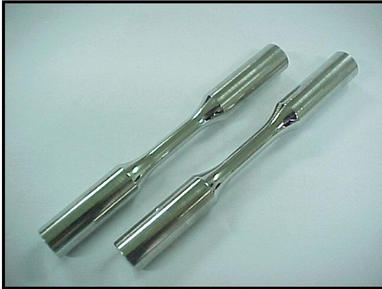
Figura 3.11: Corpos-de-prova em condições de ensaio.
