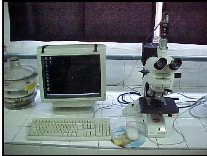
Figura 3.4: Microscópio LEICA DMLM e analisador de imagens. LabMat-FEI.
