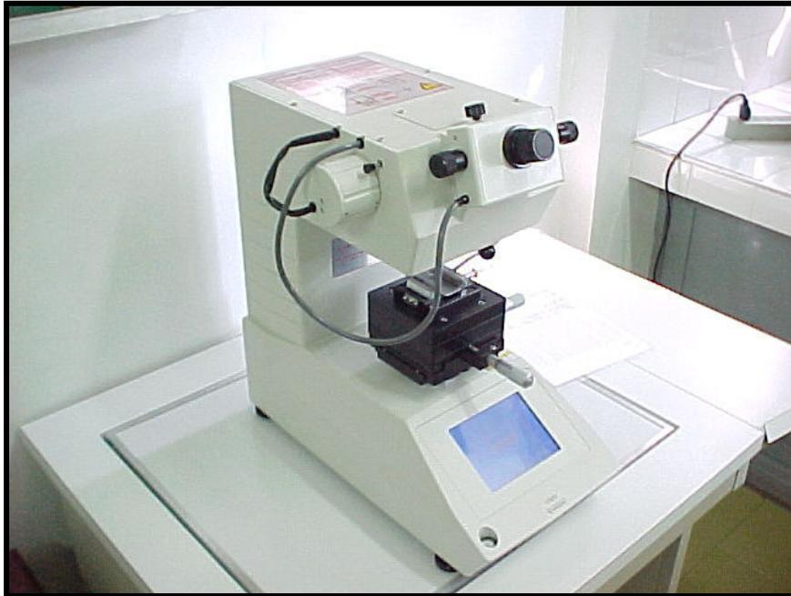
Figura 3.5: Microdurômetro Shimadzu. LabMat-FEI.
