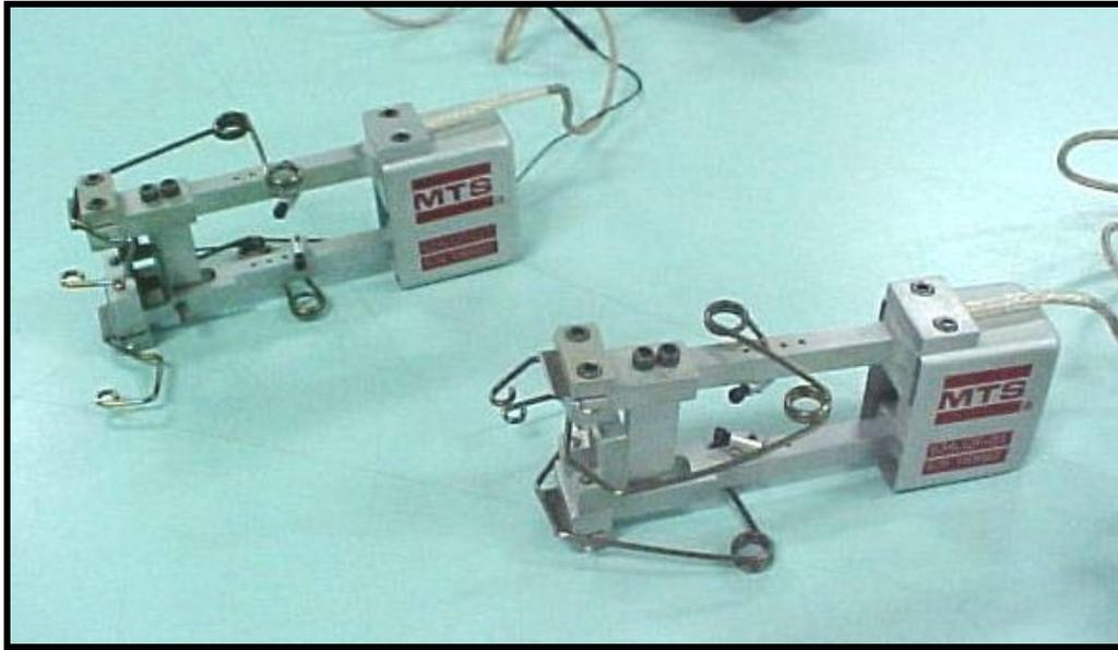
Figura 3.14: extensômetros MTS 25mm de fadiga (esquerda) e de tração (direita).
