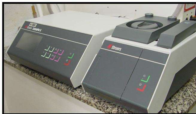
Figura 3.3: máquina Struers Lectropol utilizada para a realização do ataque eletrolítico com solução de Ácido oxálico. LabMat-FEI.
