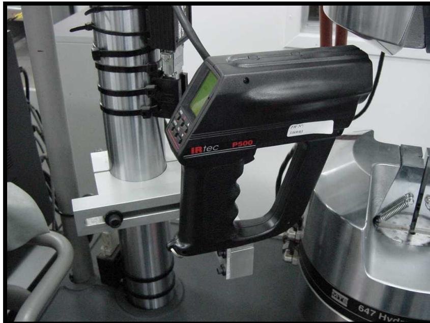
Figura 3.15: pirômetro acoplado à máquina MTS. LabMat-FEI.
