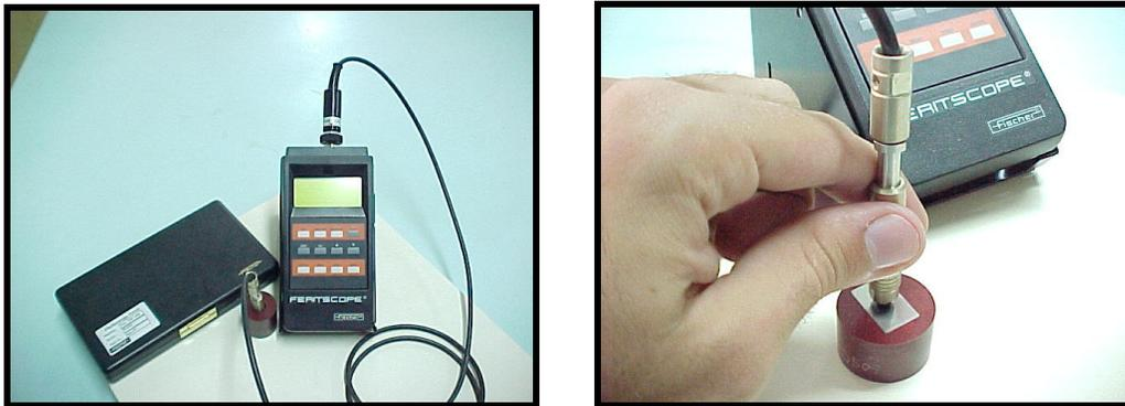
Figura 3.6: Ferritoscópio Fischer. LabMat-FEI.
