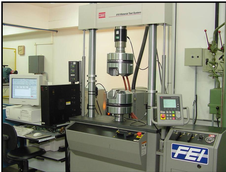
Figura 3.12: Máquina universal de ensaios MTS, com capacidade máxima de 250 kN, servo-controlada, dotada de controlador *Teststar II*. LabMat-FEI.
