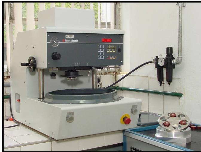
Figura 3.2: máquina Struers Abramin utilizada para os procedimentos de lixamento e polimento dos corpos de prova. LabMat-FEI.
