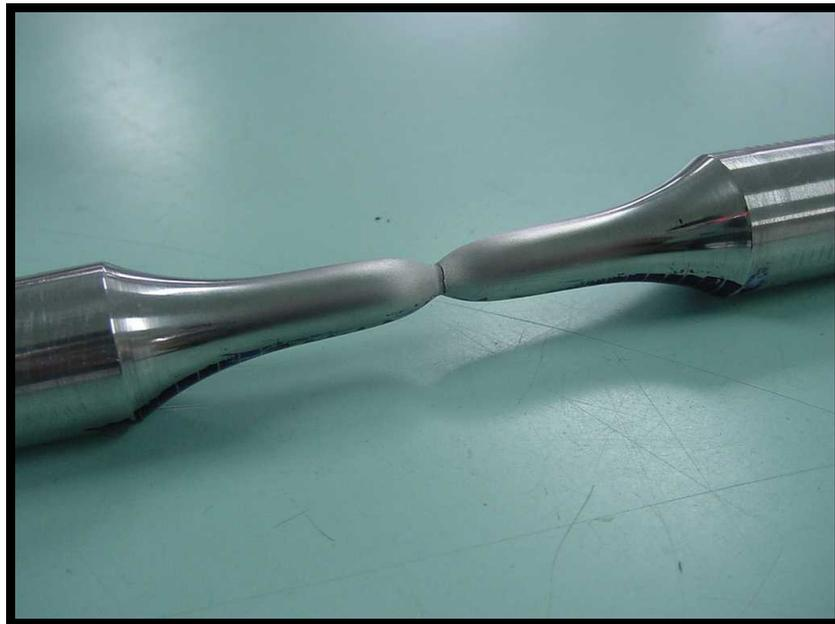
Figura 4.2: Visão geral da fratura do tipo taça cone em aço inoxidável dúplex SAF 2205.
