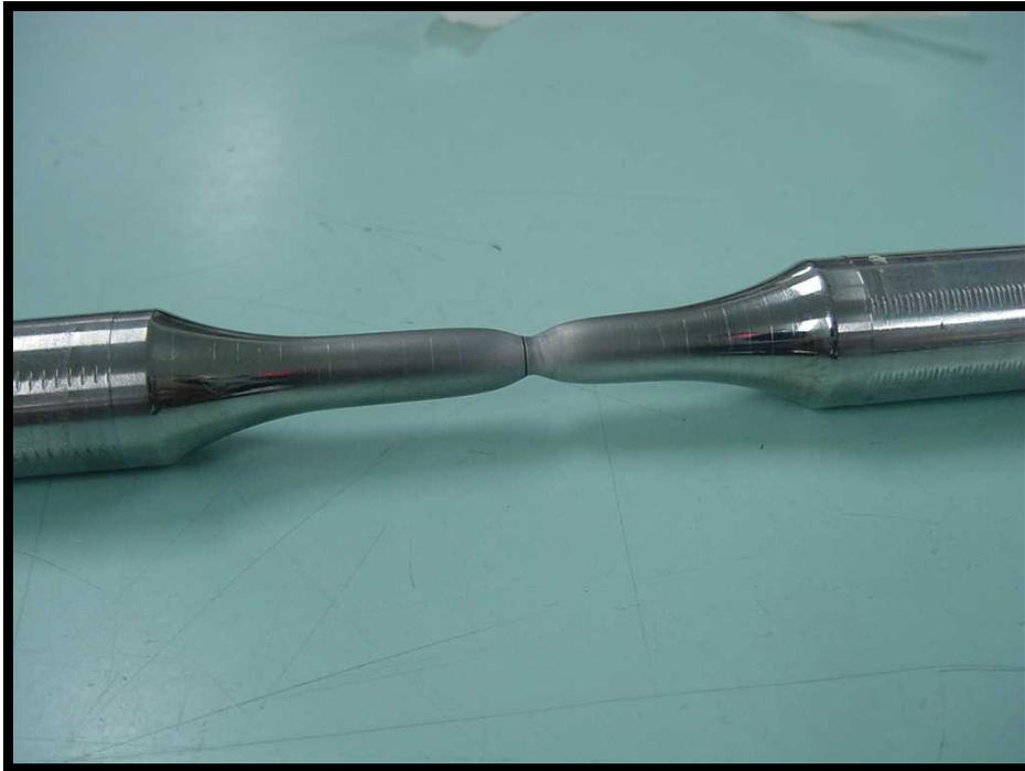
Figura 4.5: Visão geral da fratura do tipo taça cone em aço inoxidável duplex SAF 2507.
