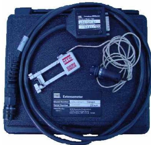
Figura 24: Extensômetro com curso útil de 25 mm utilizado para controlar por deformação os ensaios de fadiga de baixo ciclo.
