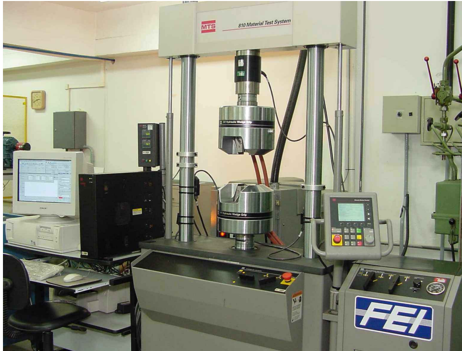
Figura 21: Máquina universal de ensaios MTS utilizada na realização dos ensaios de tração e de fadiga de baixo ciclo, com capacidade de carga de 250kN.
