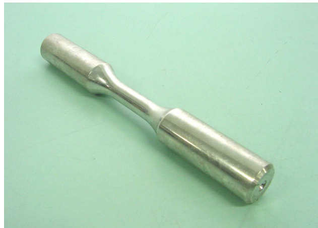
Figura 23: apresentação ilustrativa do corpo-de-prova utilizado para a realização dos ensaios de tração e de fadiga de baixo ciclo.
