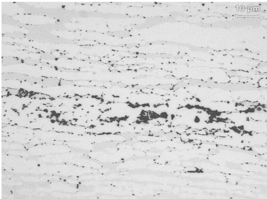
Micrografia 4.14: Amostra de aço SAF 2205 envelhecido por 8min a 800°C. Sigma (escura). Ataque: KOH.
