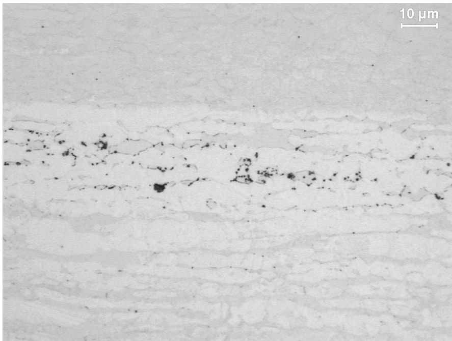
Micrografia 4.19: Amostra de aço SAF 2205 envelhecido por 1min a 850°C. Sigma (escura). Ataque: KOH.
