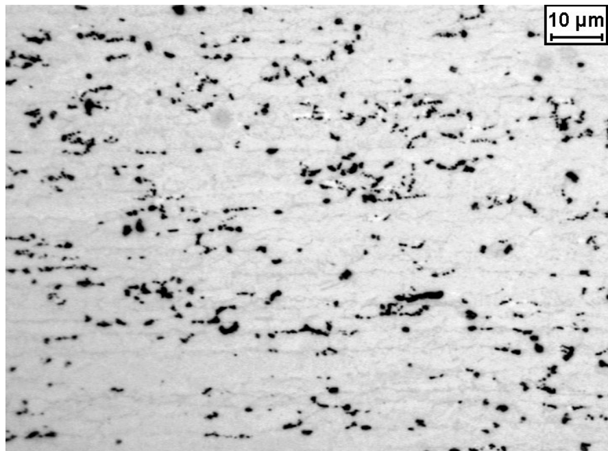
Micrografia 4.26: Amostra de aço SAF 2205 envelhecido por 5min a 900°C. Sigma (escura). Ataque: KOH.
