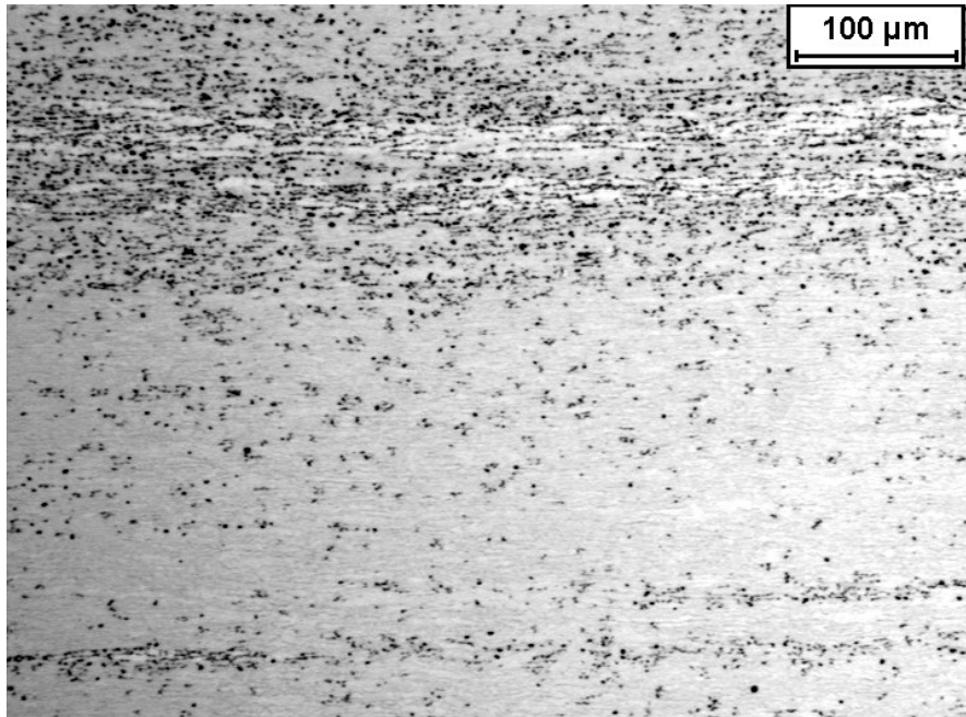
Micrografia 4.29: Amostra de aço SAF 2205 envelhecido por 10min a 900°C. Sigma (escura). Ataque: KOH.
