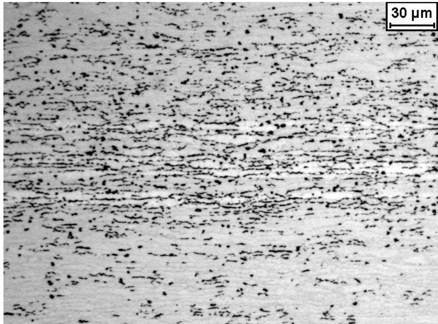
Micrografia 4.27: Amostra de aço SAF 2205 envelhecido por 8min a 900°C. Sigma (escura). Ataque: KOH.
