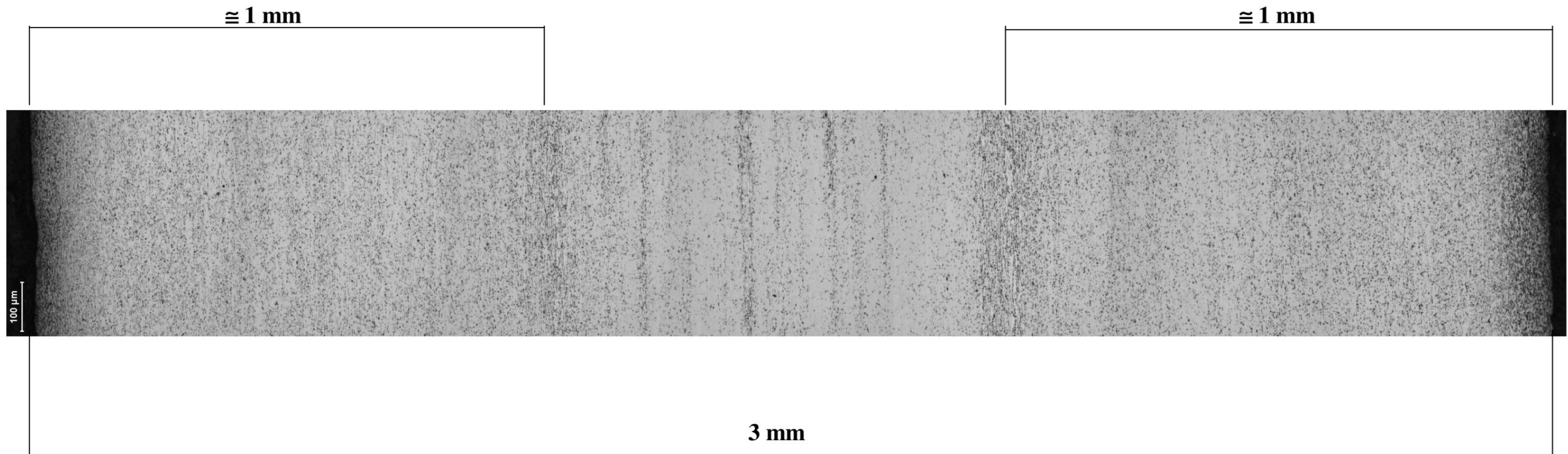
Montagem: Seção transversal da amostra envelhecida a 850°C por 10 minutos mostrando maior formação de sigma em regiões onde a microestrutura de ferrita é mais grosseira. Ataque eletrolítico: em solução 10% KOH.
