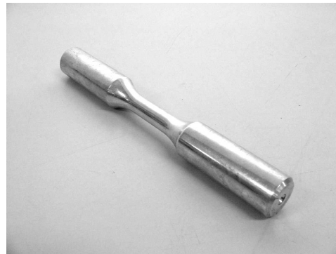
Figura 20. Foto do corpo-de-prova de tração
