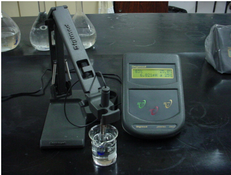
Figura 26 : pHMetro DIGIMED DM-21. - Lab. Proc. Eletroquímicos-EPUSP.
