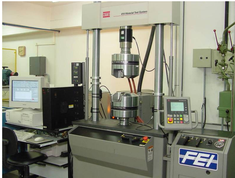
Figura 25 : Máquina universal de ensaios MTS utilizada na realização dos ensaios de tração, com capacidade de carga de 250kN. LabMat-FEI.
