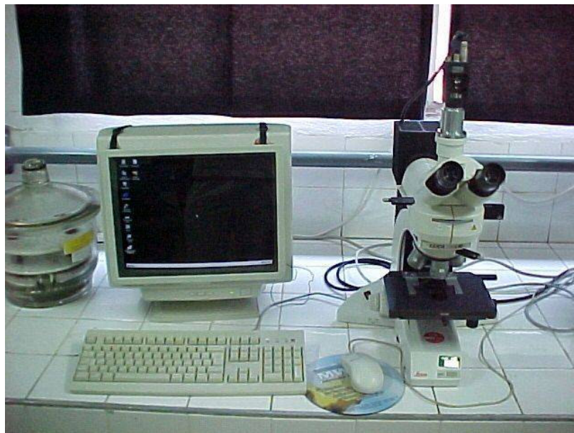
Figura 22: Microscópio LEICA DMLM e analisador de imagens. LabMat-FEI
