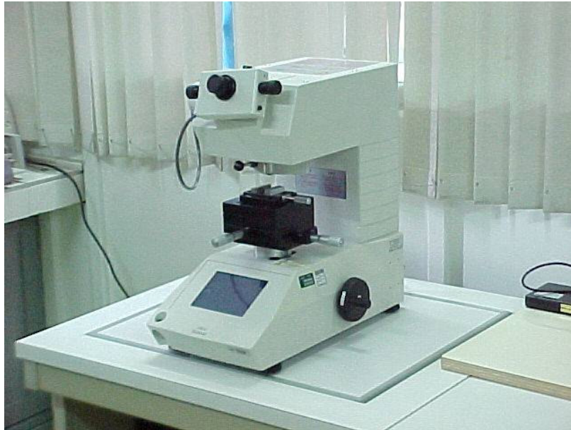
Figura 24 : Microdurômetro SHIMADZU. LabMat-FEI
