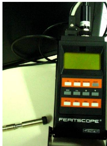
Figura 23 : Ferritoscópio FISCHER modelo MP30. LabMat-FEI
