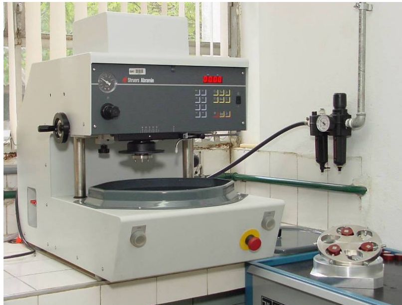
Figura 21: Máquina STRUERS ABRAMIN utilizada para os procedimentos de lixamento e polimento dos corpos de prova. LabMat-FEI
