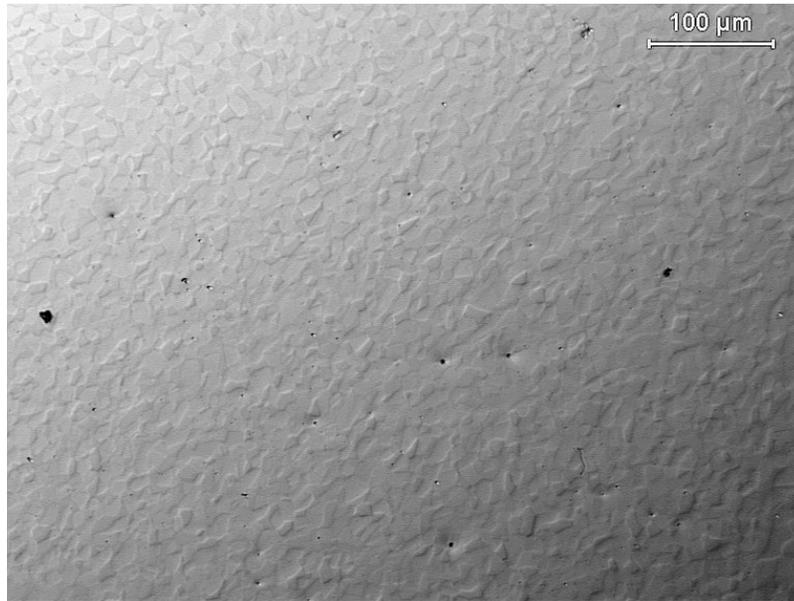
**Micrografia 4.17.** Superfície da amostra do aço SAF 2507 após polarização cíclica em 0,3M NaCl + 0,3M NaBr com  $\Delta_{irev} = 10^{-3} \text{ A/cm}^2$ .
