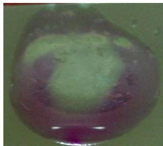
Figura 23: Distinção de duas regiões, sendo uma de coloração esbranquiçada localizada ao centro da gota e a outra de coloração rósea localizada na periferia, dezesseis minutos após o início do experimento com uma solução 1 N em  $\text{Na}_2\text{SO}_4$ .
