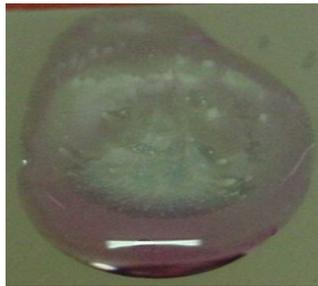
Figura 22: Início do agrupamento das áreas esbranquiçadas a fim de formar uma região central, permanecendo a periferia com uma coloração rósea, seis minutos após o início do experimento com uma solução 1 N em  $\text{Na}_2\text{SO}_4$ .
