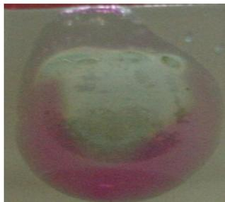
Figura 25: Término do experimento, quando a região central pára de expandir em direção à periferia, aos trinta minutos de experimento com uma solução 1 N em  $\text{Na}_2\text{SO}_4$ .
