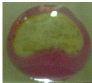
Figura 19 : Aumento da região central, agora de coloração marrom, que termina aos doze minutos de experimento com uma solução 3,5% em massa de KCl.
