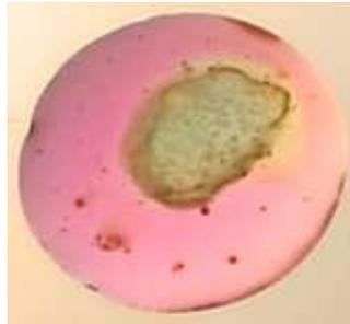
Figura 4: Aumento progressivo da região marrom (ferrugem), tanto em direção ao centro da gota como em direção à periferia, sendo, porém, mais efetiva em direção ao centro da gota, mostrado dezoito minutos após o início do experimento com solução 3,5% em massa de NaCl.
