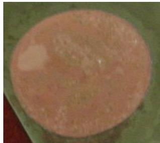
Figura 27: Essa figura mostra o detalhe de como fica a superfície metálica quando enxugamos o líquido da gota contendo uma solução 0,5 M de  $\text{CuSO}_4$ .
