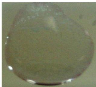
Figura 20: Início do aparecimento da coloração rósea nas bordas da gota (característica da região catódica), com indícios do aparecimento de regiões anódicas dispersas pela superfície da gota, aqui mostrado um minuto após o início do experimento com uma solução 1 N em  $\text{Na}_2\text{SO}_4$ .
