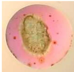
Figura 6: Desaparecimento total da região azul, caracterizando o que *Evans* [1926] costumava chamar “*blue fading*”, que ocorre trinta minutos após o início do experimento com solução 3,5% em massa de NaCl.
