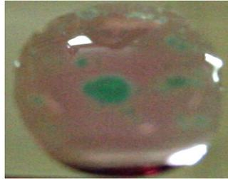
Figura 7: Distribuição aleatória das regiões anódica e catódica sobre a superfície metálica, com regiões de coloração azul (anódicas) e rosa (catódicas) distribuídas ao acaso, após um minuto da colocação da gota de uma solução aerada 3,5% em massa de NaCl sobre o metal.
