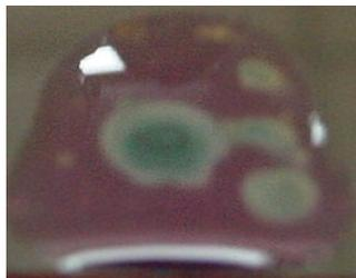
Figura 10: Avanço da região de coloração esbranquiçada tanto em direção ao centro da gota quanto em direção à periferia, aqui mostrada oito minutos após o início do experimento com solução aerada 3,5% em massa de NaCl.
