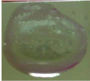
Figura 21: Intensificação da coloração rósea na borda da gota, enquanto as regiões azuis se tornam esbranquiçadas, três minutos após o início do experimento com uma solução 1 N em  $\text{Na}_2\text{SO}_4$ .
