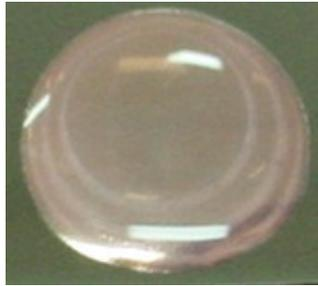
Figura 26: Deposição de cobre sobre a superfície metálica instantaneamente após a colocação de uma gota contendo  $\text{CuSO}_4$ , não havendo, portanto a formação de áreas anódicas e catódicas.
