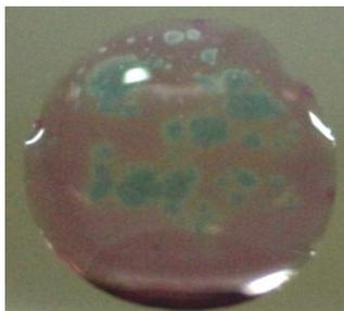
Figura 15: Distribuição aleatória das regiões anódica e catódica sobre a superfície metálica, com regiões de coloração azul (anódicas) e rosa (catódicas) distribuídas ao acaso, após um minuto da colocação de uma gota de solução 3,5% em massa de KCl sobre o metal.
