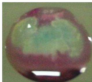
Figura 17: Avanço da região de coloração esbranquiçada tanto em direção ao centro da gota quanto em direção à periferia da gota com uma mudança progressiva dessa coloração para uma tonalidade mais bege (ou marrom) enquanto há uma diminuição significativa da coloração azul central, aqui mostrada seis minutos após o início do experimento com uma solução 3,5% em massa de KCl.
