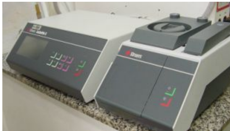
Figura 19: máquina Struers Lectropol utilizada para a realização do ataque eletrolítico com solução de KOH. LabMat-Fei.
