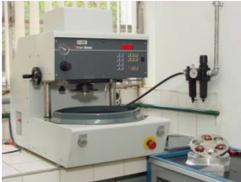
Figura 18: máquina Struers Abramin utilizada para os procedimentos de lixamento e polimento dos corpos de prova. LabMat-Fei.
