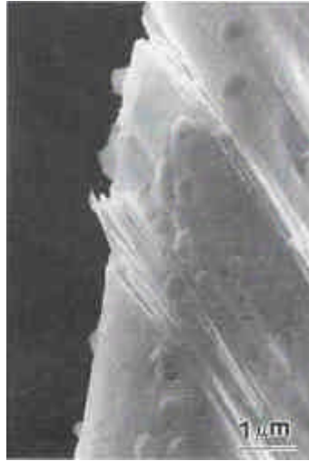
Figura 5: intrusões e extrusões em cobre [1] .
