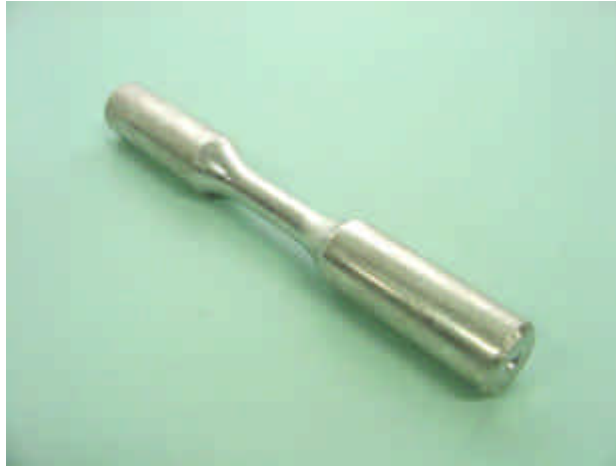
Figura 20: apresentação ilustrativa do corpo-de-prova utilizado para a realização dos ensaios de tração e de fadiga de baixo ciclo.
