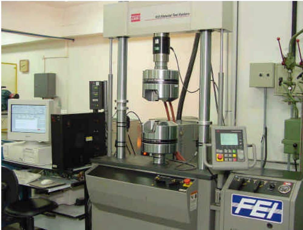
Figura 19: Máquina universal de ensaios MTS utilizada na realização dos ensaios de tração e de fadiga de baixo ciclo, com capacidade de carga de 250kN.
