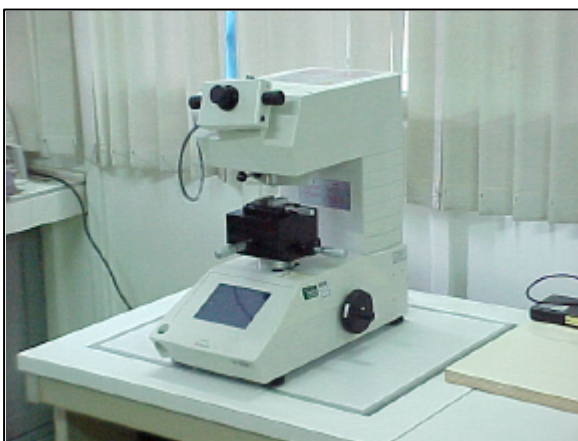
Figura 3.4. Microdurômetro modelo HMV-2, fabricado por SHIMADZU do LabMat - FEI
