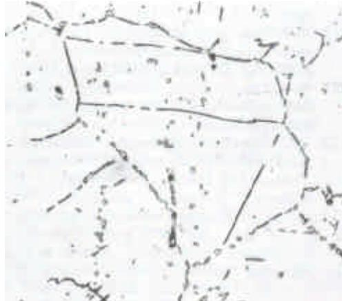
*Figura 6: Aço inoxidável AISI 316, exposto durante 3000h a 815°C (1500F). A exposição prolongada nessa temperatura resultou na formação de ilhas de sigma (**s**) e chi (**c**) nos contornos de grão da austenita. Ataque com Picral e HCL. 500X<sup>[5]</sup>*
