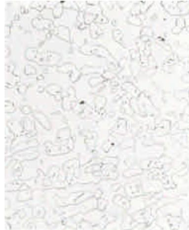
Figura 2: Aço inoxidável Dúplex AISI 312 (250HV); Secção transversal mostra a austenita em uma matriz de ferrita. Ataque com Glicerégia. 200X<sup>[5]</sup>.
