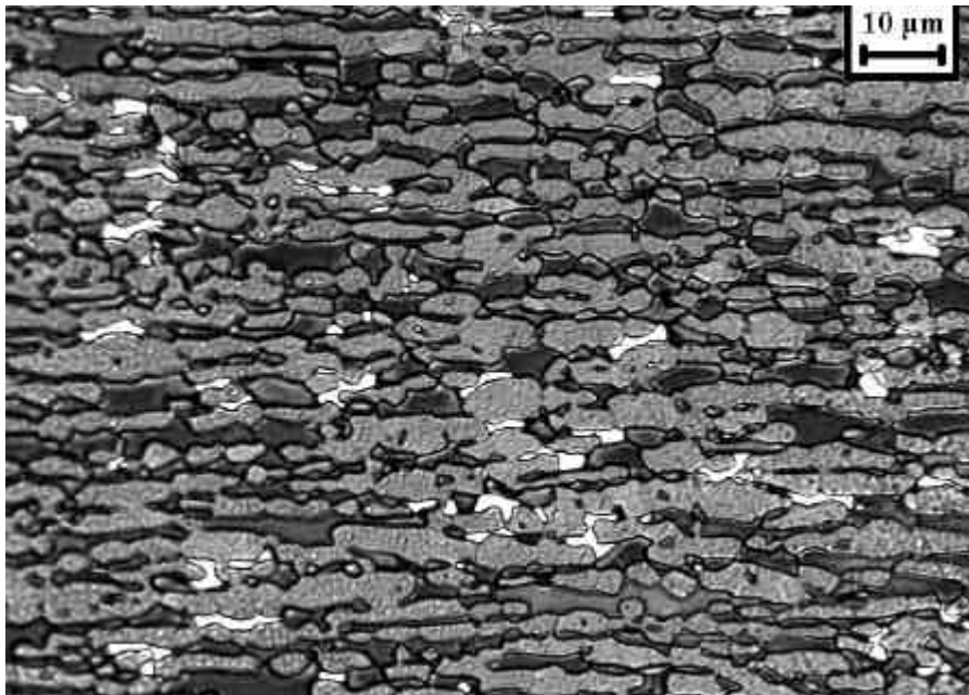
Micrografia 5.3. Amostra envelhecida a 900°C por 20 minutos. Ferrita (escura), austenita (cinza) e sigma (sem ataque). Ataque: Behara modificado
