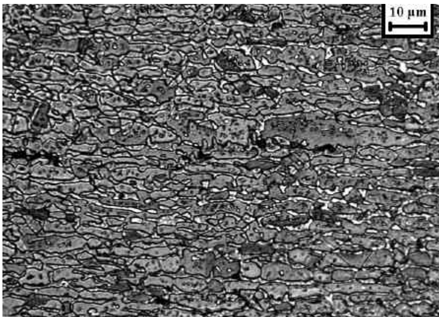
Micrografia 5.47. Amostra envelhecida a 750°C por 384 horas. Austenita (cinza) e sigma sem ataque. Ataque: Behara Modificado.
