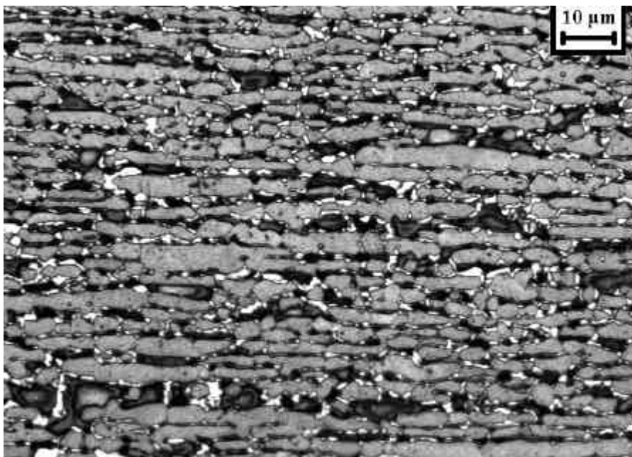
Micrografia 5.37. Amostra envelhecida a 750°C por 1 hora. Ferrita (escura), austenita (cinza) e sigma sem ataque. Ataque: Behara Modificado.
