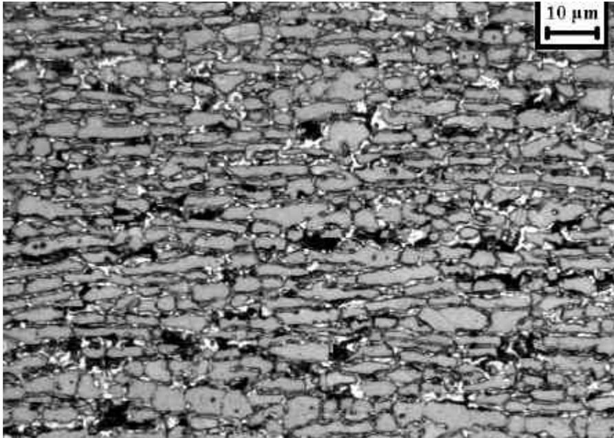
*Micrografia 5.62. Amostra envelhecida a 700°C por 48 horas. Ferrita (escura), austenita (cinza) e sigma sem ataque. Ataque: Behara Modificado.*
