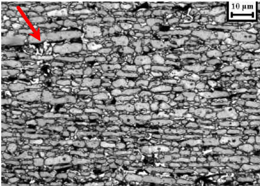
*Micrografia 5.61. Amostra envelhecida a 700°C por 24 horas. Ferrita (escura), austenita (cinza) e sigma sem ataque. Ataque: Behara Modificado. A seta indica uma região de decomposição eutetóide da ferrita.*
