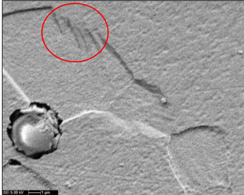
Figura 110: Micrografia com aumento da região da Figura 97 da amostra 12 (com 55% de deformação).
