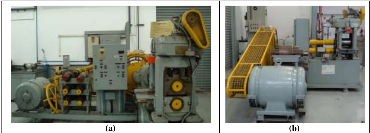
Figura 18: Laminador de produtos planos do CDMatM-FEI. (a) vista lateral; (b) vista frontal.
