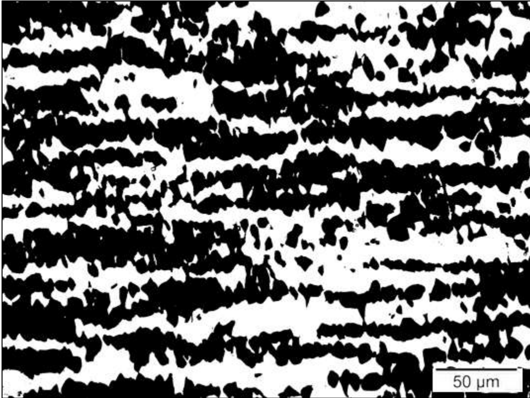
Figura 64: Amostra12, 55% deformada, plano da seção transversal. Ataque: Beraha. Aumento: 20x.
