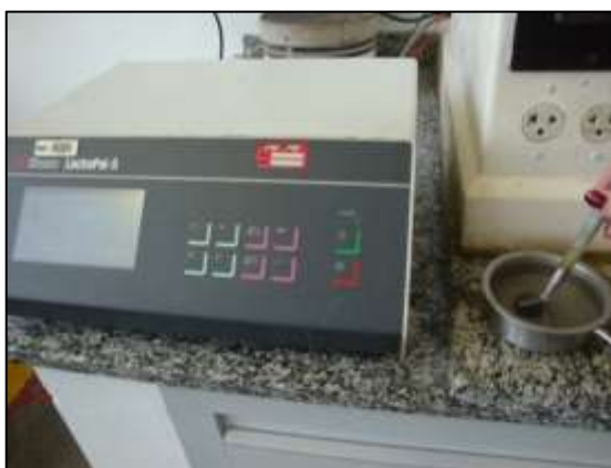
Figura 23: Realização do ataque eletrolítico com solução 10% de ácido oxálico. Fonte: Autor
