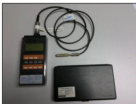
Figura 26: Ferritoscópio FISCHER modelo MP30 e o padrão de calibração à direita. Fonte: Autor.
