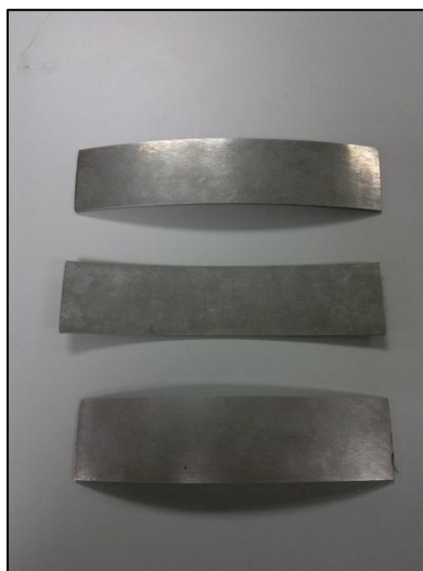
Figura 14: As três chapas do aço inoxidável dúplex SAF 2205. Fonte: Autor.
