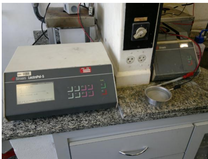
Figura 28: Equipamento STRUERS ELECTROPOL para ataque com ácido oxálico. Fonte: Autor.
