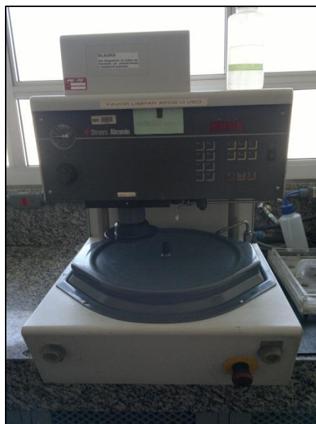
Figura 24: Máquina de lixamento e polimento semi-automático Struers Abramin. Fonte: Autor.
