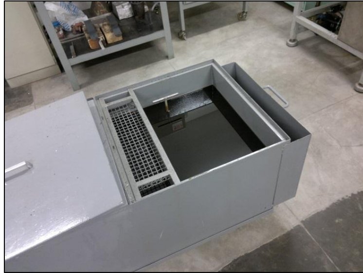
Figura 22: Recipiente com água onde foram resfriadas as amostras solubilizadas. Fonte: Autor.
