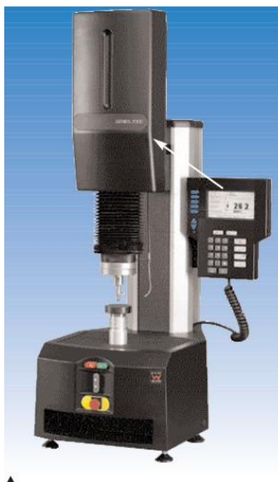
Figura 12 - - Durômetro INSTRON utilizado para avaliar a dureza dos corpos de prova – Mangels Ind. Com. Ltda.
