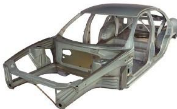
Figura 1 – Exemplo de aplicação dos aços AHSS ( Advanced High Strength Steel ) na estrutura de um automóvel.
