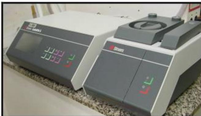
Figura 19: Máquina STRUERS LECTROPOL utilizada para polimento eletrolítico das amostras.
