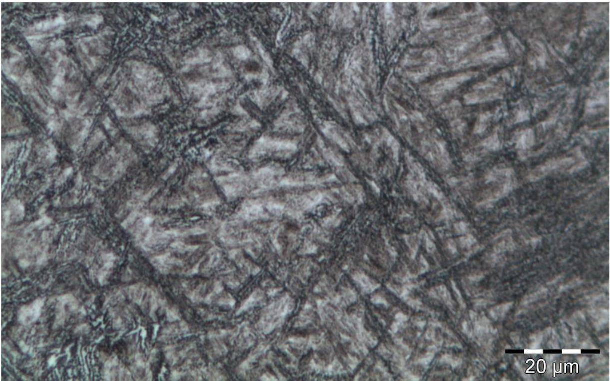
Figura 34: Micrografia do ponto D (ZTA) com aumento de 500x.
