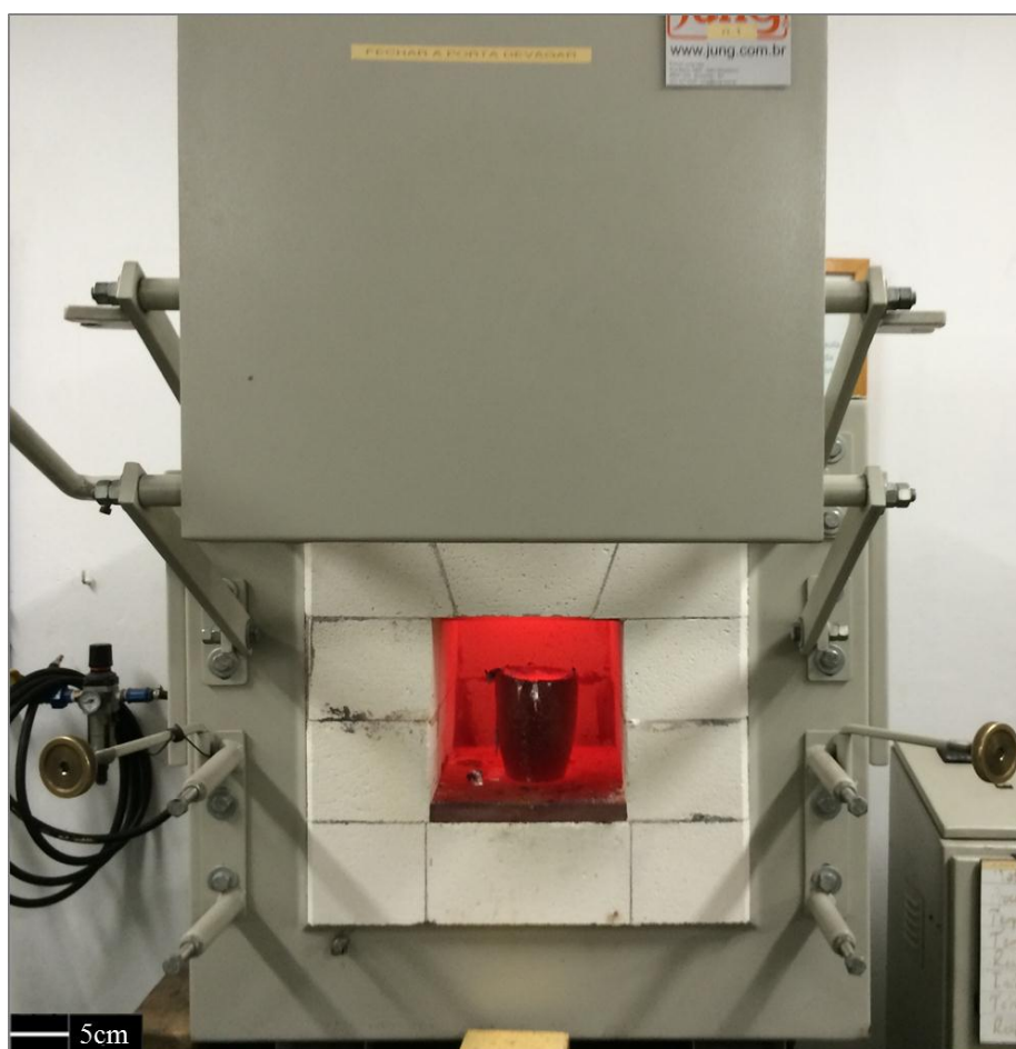
Figura 35 - Forno Jung utilizado para envelhecimento mais curtos das amostras, com o cadinho contendo alumínio líquido.
