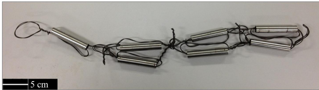
Figura 29 - Tubos de aço SAF 3207 amarrados para a solubilização a 1100°C.
