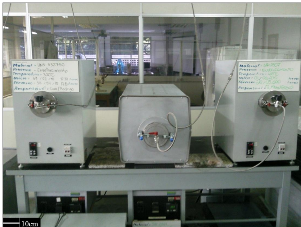
Figura 30 - Fornos tubulares da FEI usados para solubilização e envelhecimento das amostras.
