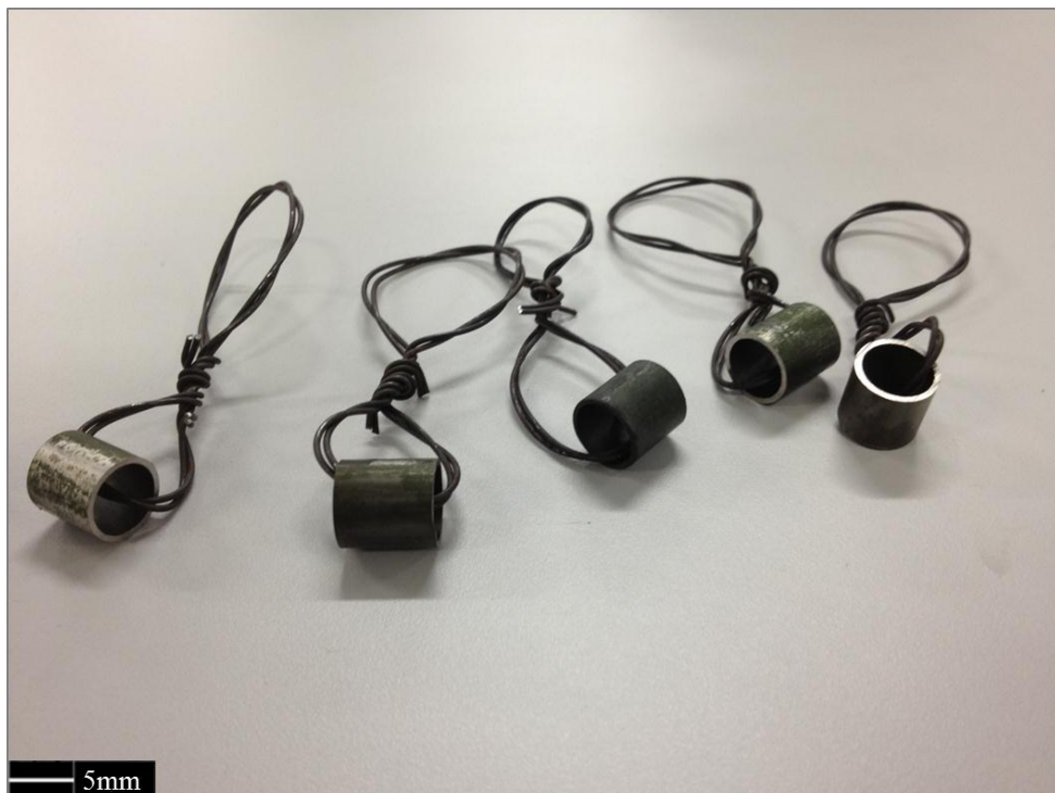
Figura 34 - Material cortado em anéis com altura de aproximadamente 8 mm e amarrados para o envelhecimento a 800°C.
