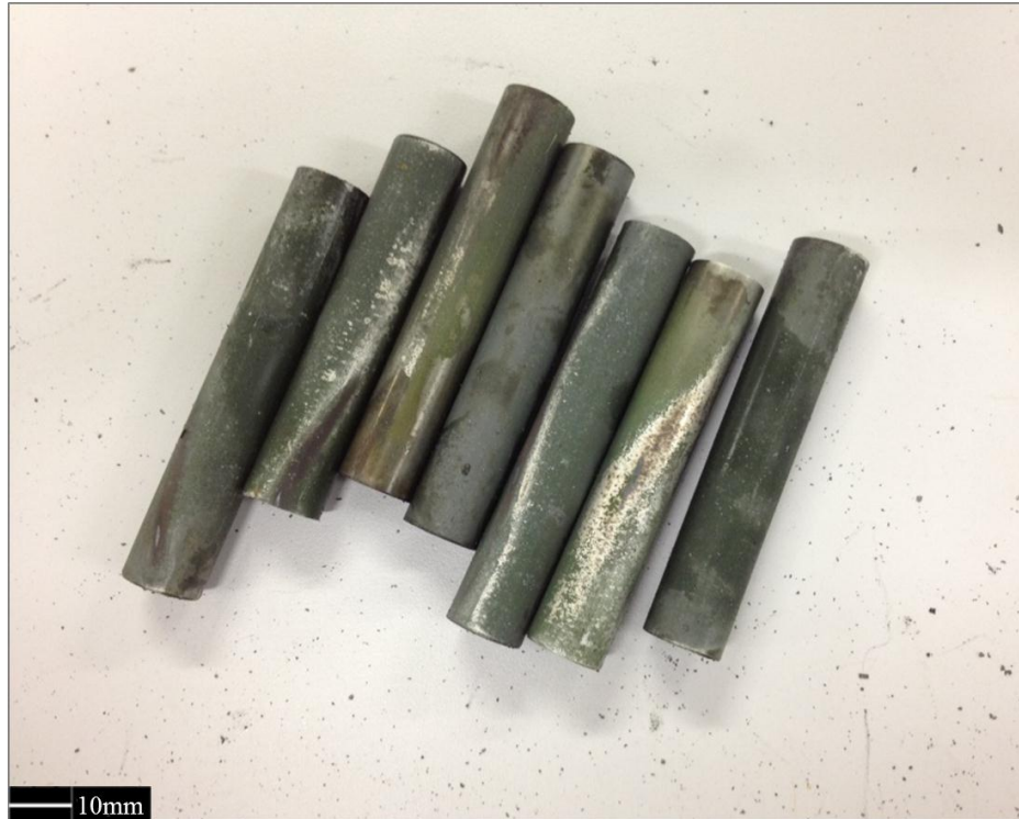
Figura 32 - Tubos de aço SAF 3207 depois da solubilização a 1100°C.
