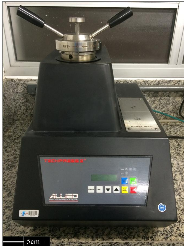
Figura 37 - Equipamento de embutimento semi-automático TECHPRESS 2 - ALLIED. Fonte: ALLIED, 2014.
