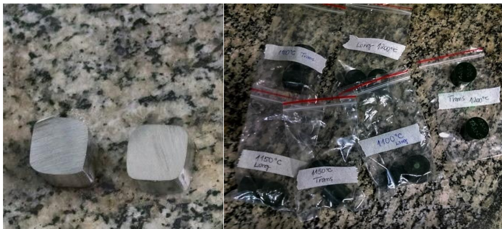
Figura 11 - (a) Corpos de prova na transversal com dimensões parecidas e (b) Corpos já embutidos e separados conforme categoria e temperatura.
