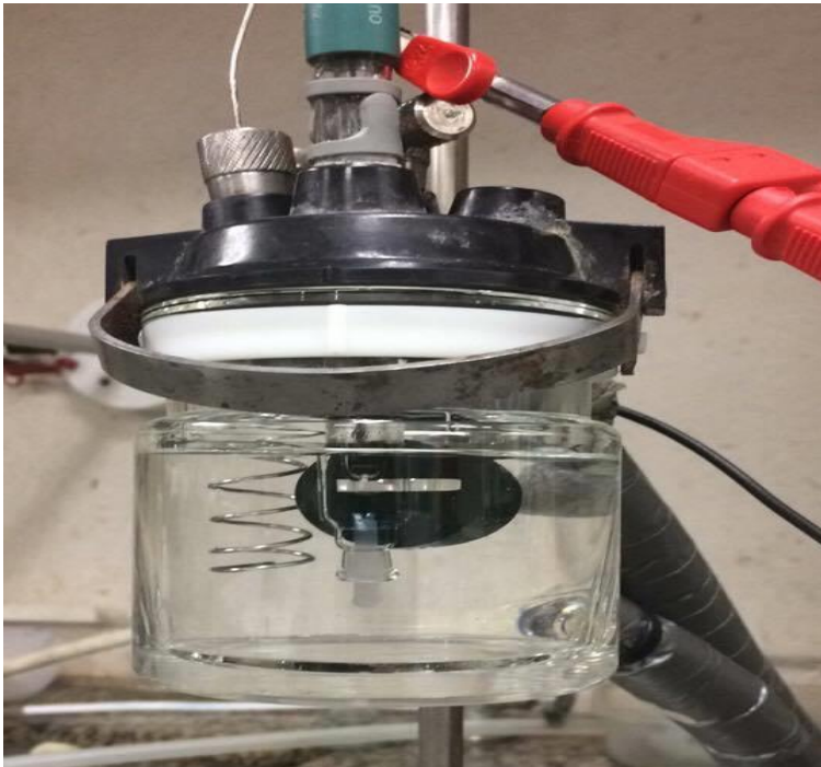
Figura 9 – Montagem da célula eletroquímica para ensaios potenciodinâmicos e potencioestáticos na solução de HCl 1M a 30°C
