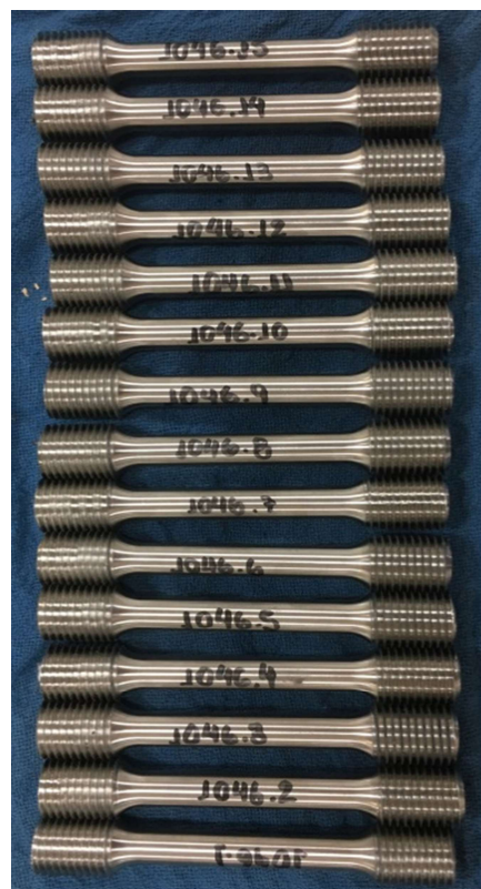
Figura 39 – (a) Instron modelo 30T do Centro de Pesquisa & Desenvolvimento utilizada para obtenção dos resultados dos ensaios de tração do material estudado; (b) Corpos-de-prova usinados para os ensaios de tração dos materiais analisados; (c) Dimensões dos corpos-de-prova 2 5D [EM8] utilizados.
