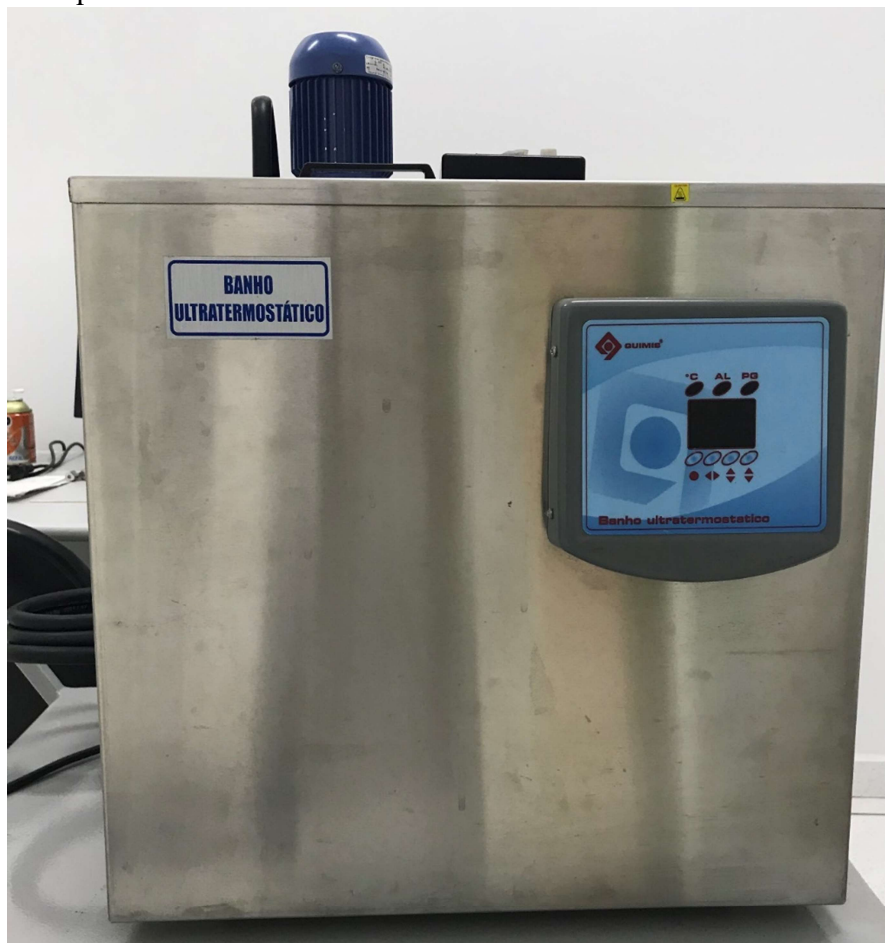
Figura 43 – Banho ultratermostático microprocessado com circulador da marca Quimis do CDMatM-FEI utilizado acoplado à célula eletroquímica encamisada para controle da temperatura dos ensaios eletroquímicos.
