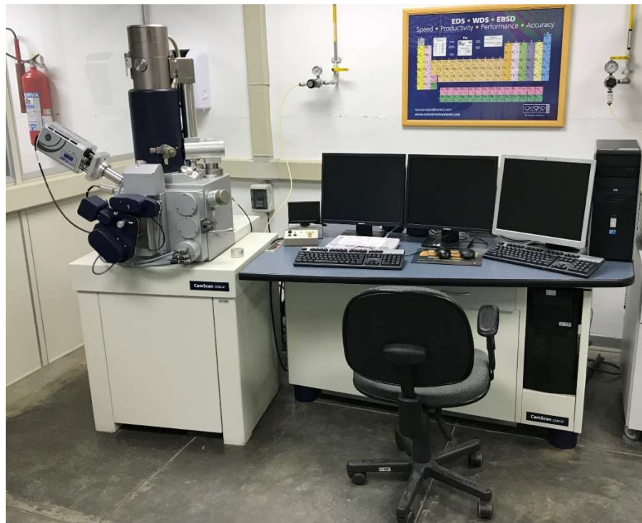
Figura 36 - Microscópio eletrônico de varredura CAMSCAN CS3200LV do CDMatM-FEI utilizado na análise das inclusões das amostras solubilizadas.
