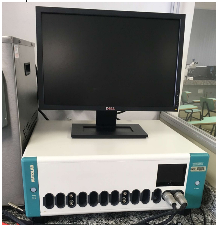
Figura 41 – Potenciostato AUTOLAB (PGSTAT 12) do CDMatM-FEI utilizado para realização dos ensaios eletroquímicos dos materiais em estudo.
