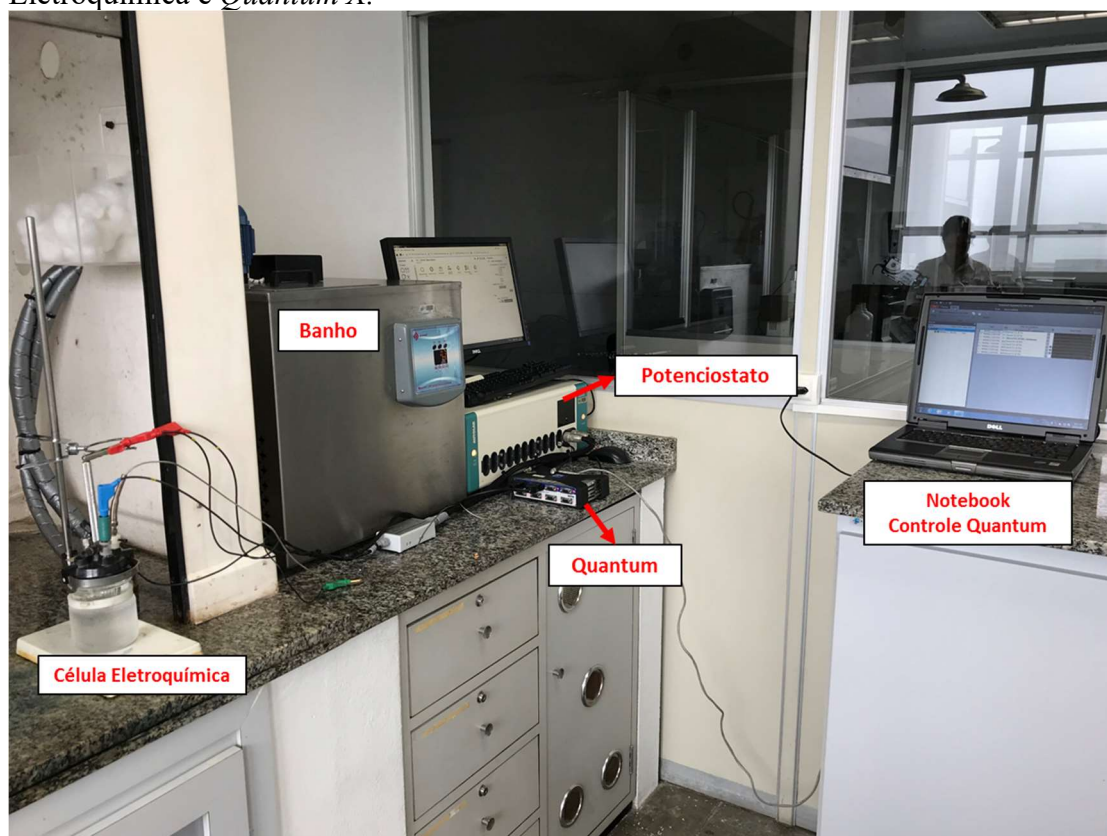
Figura 44 – Equipamentos utilizados para obtenção das curvas de temperatura crítica de pite no CDMatM-FEI: Potenciostato, Banho Ultratermostático, Célula Eletroquímica e Quantum X .
