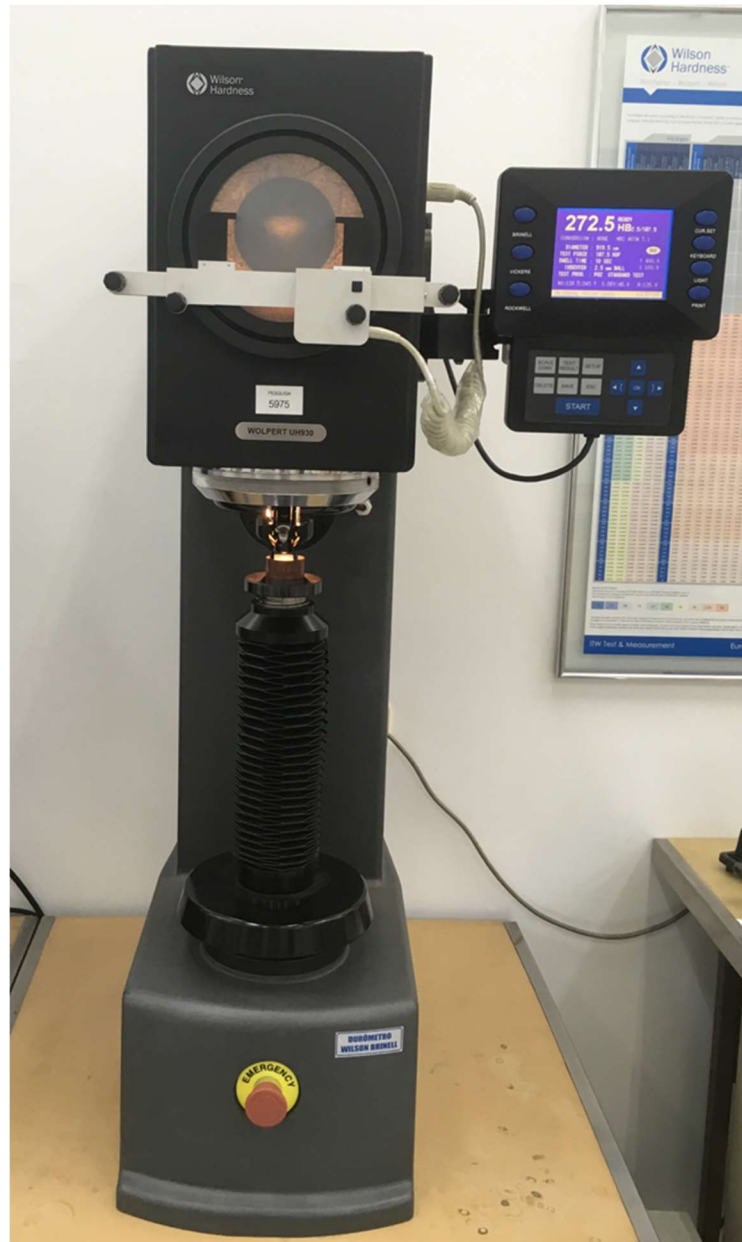
Figura 38 – Durômetro Wilson Hardness , modelo Wolpert UH930 , do Centro de Pesquisa & Desenvolvimento da Villares Metals utilizado para realização das medidas de dureza Brinell do material em estudo.
