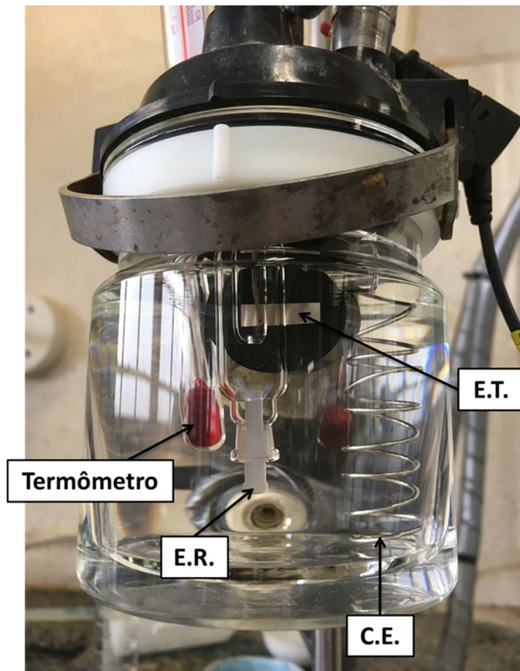
Figura 42– Configuração da célula eletroquímica utilizada nos ensaios eletroquímicos, sendo que E.R. representa o eletrodo de referência Ag/AgCl, C.E. representa o contra-eletrodo fabricado com um fio de platina e E.T. representa o eletrodo de trabalho que corresponde à amostra analisada.
