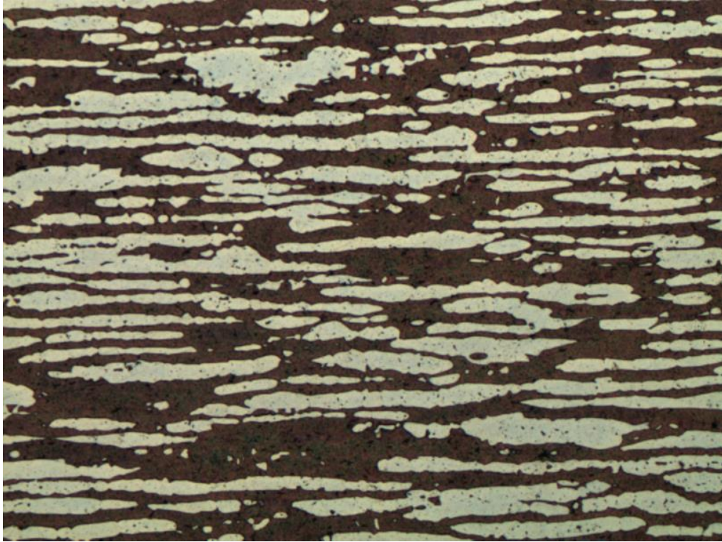
Figura 38 - Microscopia óptica da amostra 7, solubilizada a 1250°C por 60s (100x).
