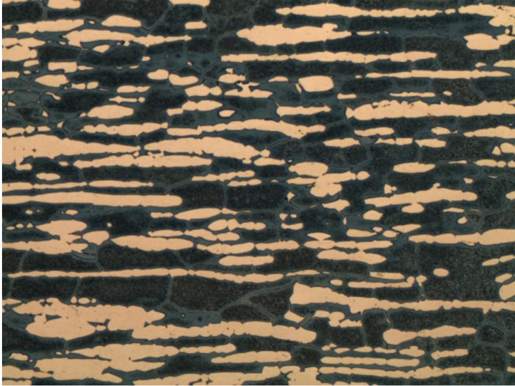
Figura 40 - Microscopia óptica da amostra 3, solubilizada a 1250°C por 1800s (100x).
