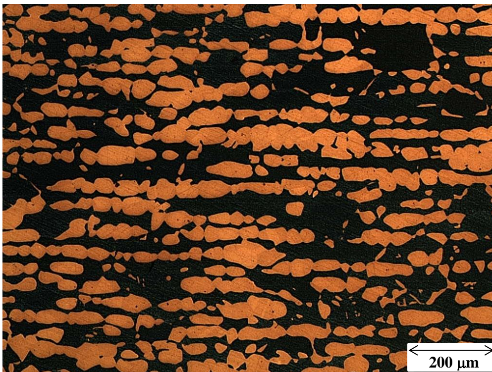
Figura 55 – Microscopia óptica da amostra 14, solubilizada a 1088°C por 12h, após ataque com Beraha modificado
