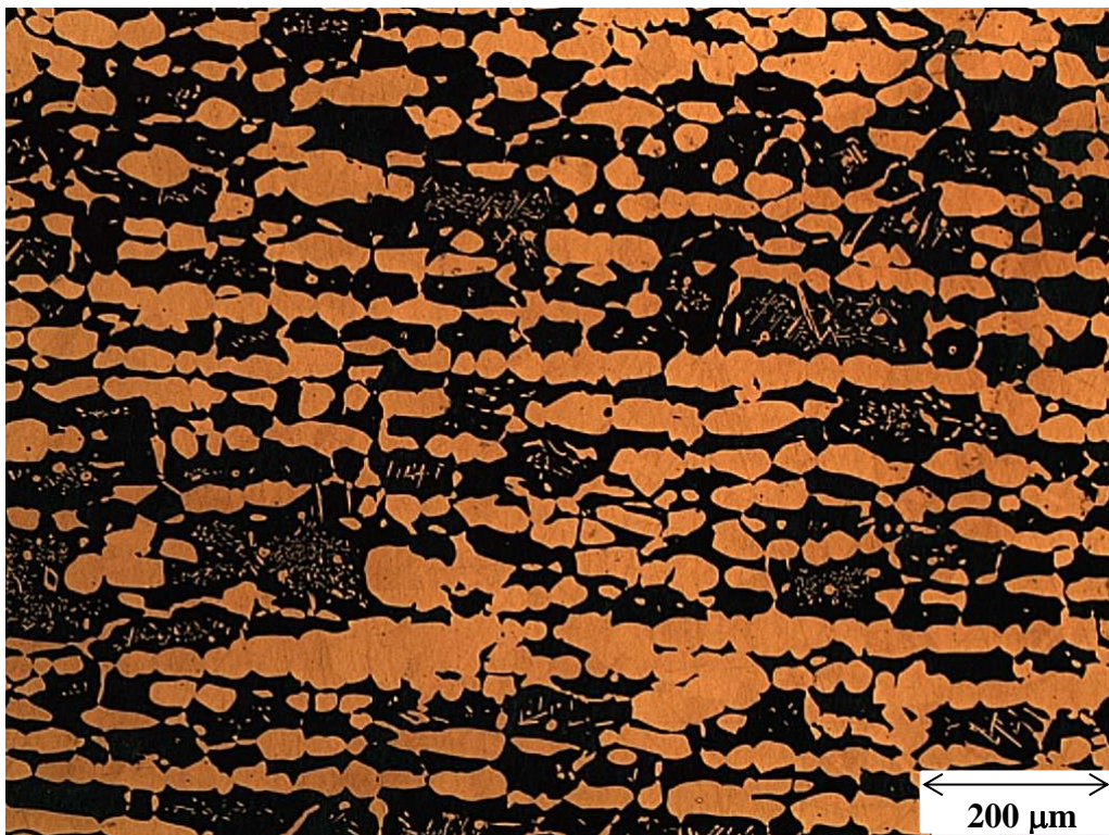
Figura 54 – Microscopia óptica da amostra 9, solubilizada a 1088°C por 3h, após ataque com Beraha modificado
