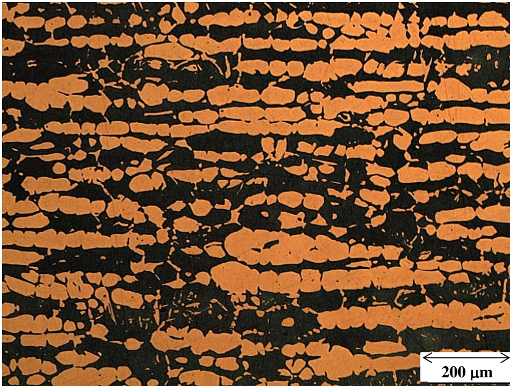
Figura 53 – Microscopia óptica da amostra 5, solubilizada a 1088°C por 1800s, após ataque com Beraha modificado
