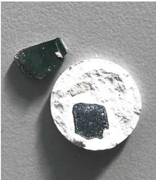
Figura 32: Oxidação da amostra Fe-Cr no briquete de caulim
