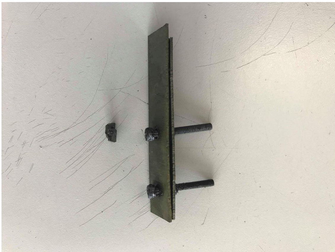
Figura 15: Dispositivo com placas de aço inoxidável, unidas por parafusos.
