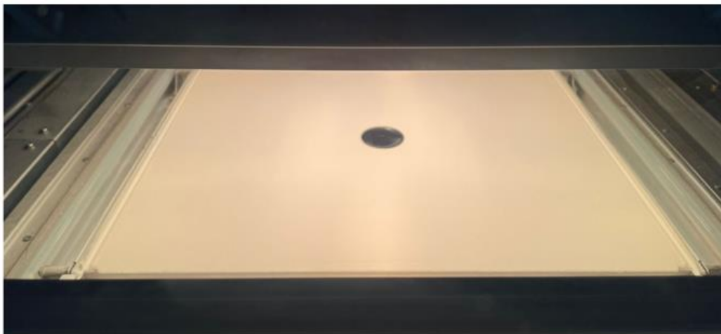
Figura 22 – Porção de agentes depositada sobre o leito de pó antes do início da impressão
