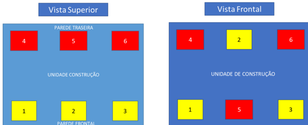
Figura 66 - Posicionamento dos grupos de impressão em relação a estação de construção (cuba) – Vista superior
