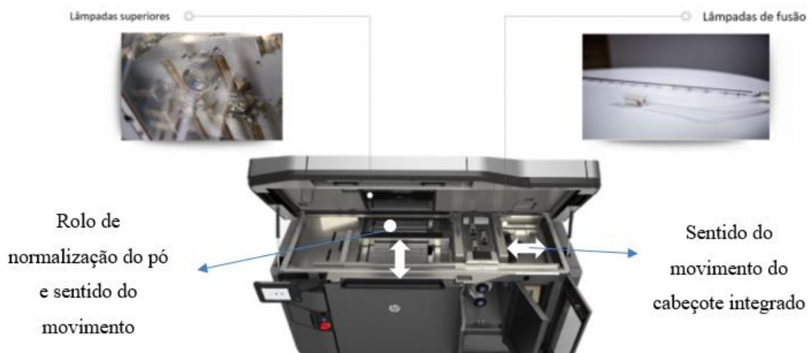
Figura 19 – Sistemas de lâmpadas do processo MJF
