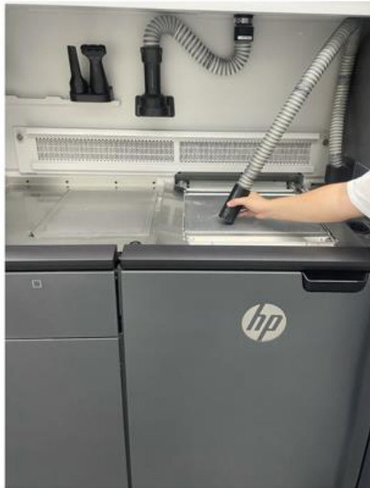
Figura 27 - Sistema de aspiração de pó não utilizado para formação de peças
