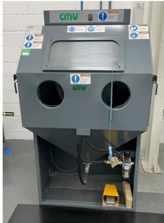
Figura 28 - Estação de pós processamento por jateamento de esferas de vidro
