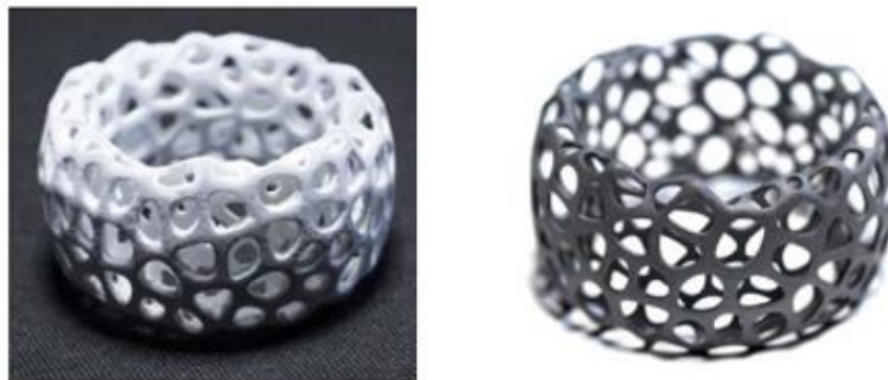
Figura 29 - Produto impresso antes (esq.) e depois (dir.) do pós processamento
