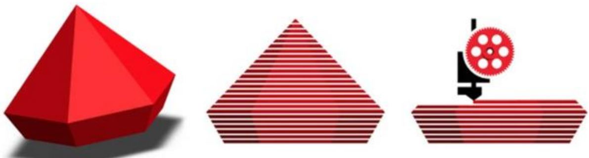
Figura 9 – Modelo 3D em sua forma original (esq.), dividido em camadas (centro) e processo de impressão de uma camada (dir.)
