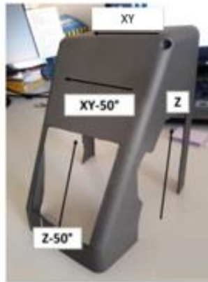
Figura 46 – Componente industrial impresso do qual foram retiradas amostras para ensaio de tração
