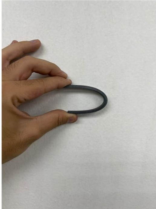
Figura 77 - Condição extrema em flexão não ocorrendo ruptura da amostra
