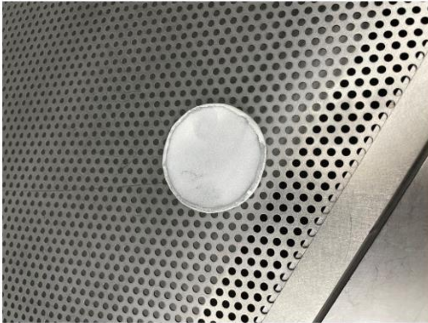
Figura 23 – Bolacha formada em todo início de impressão do processo MJF
