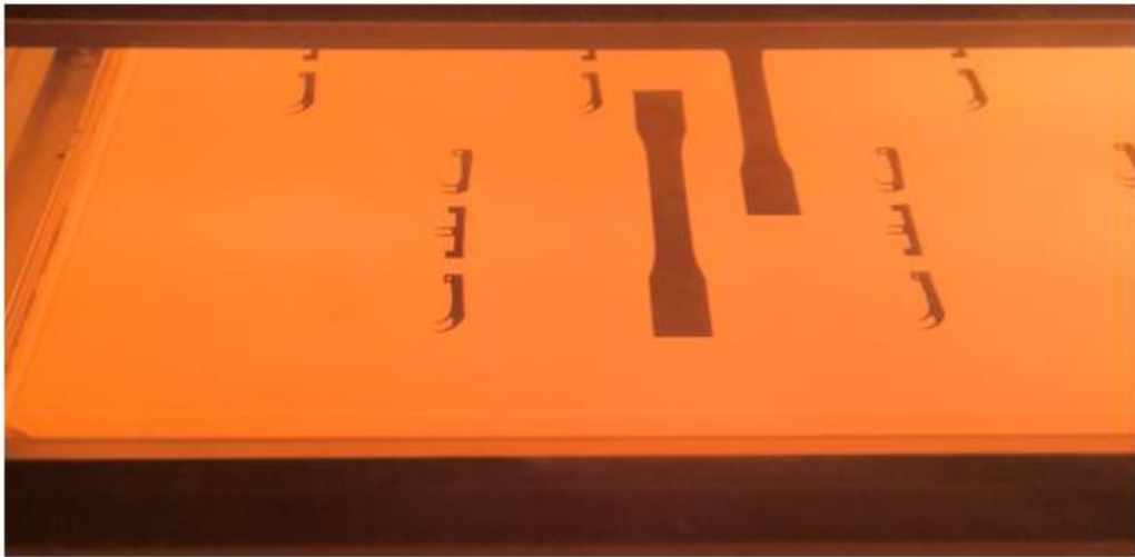
Figura 24 - Agentes aplicados sobre camada de pó durante processo de impressão
