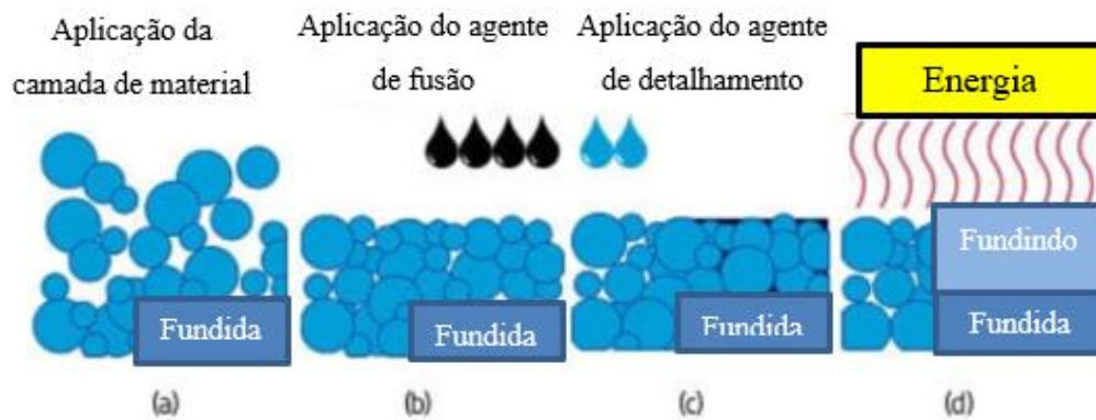
Figura 17 - Processo MJF mostrado passo a passo
