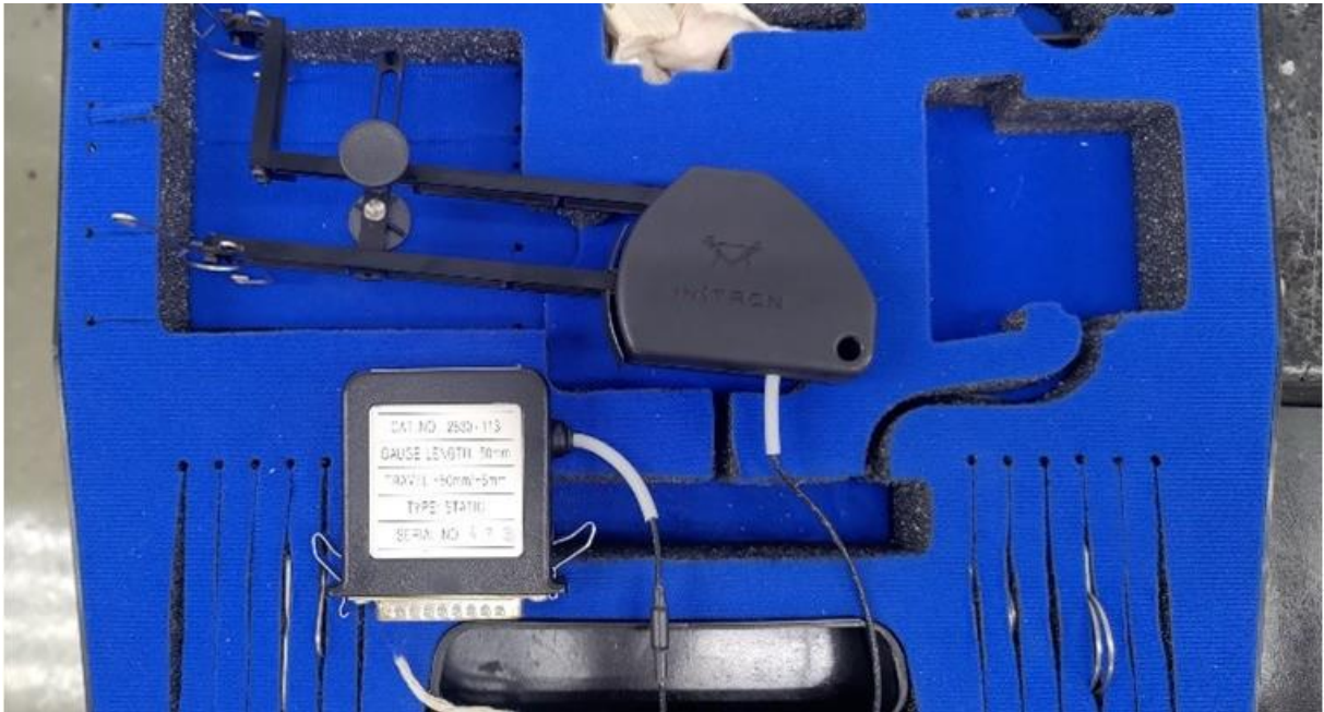
Figura 75 - Extensômetro utilizado no ensaio de tração - 50 mm com deformação máxima de 100%
