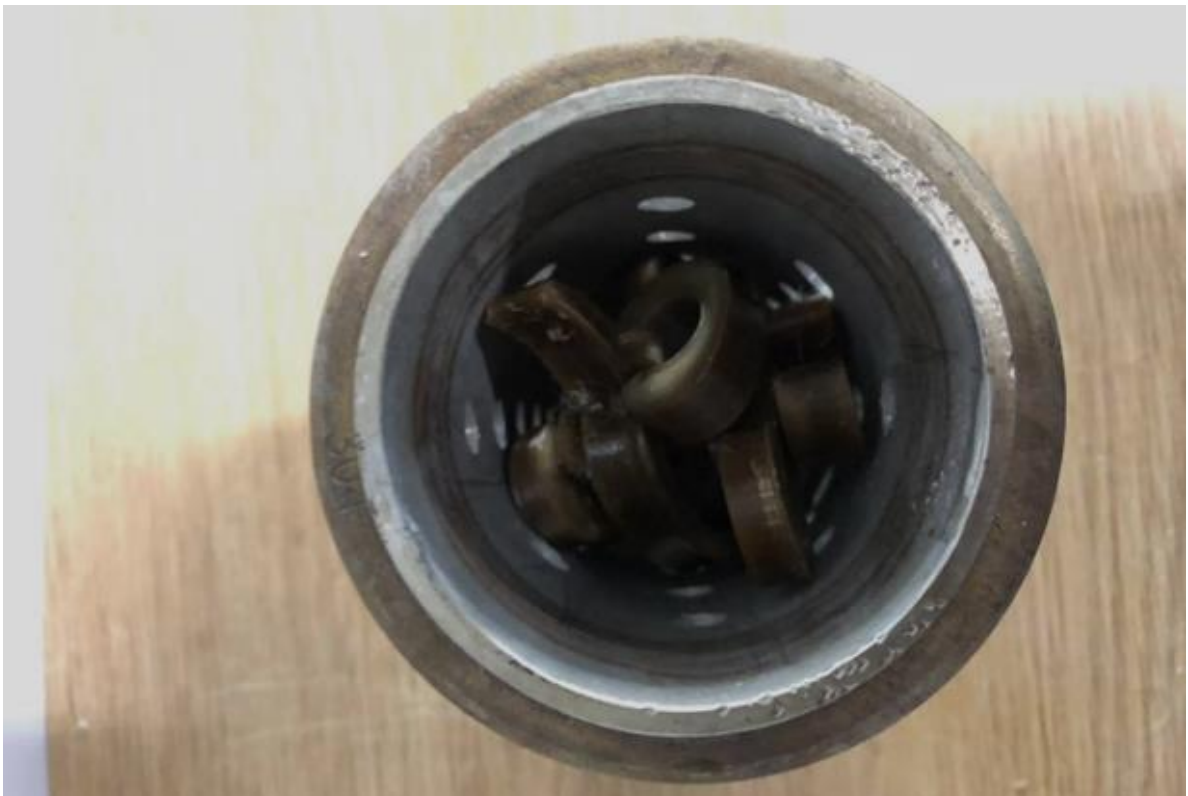
Figura 5 - Peças impressas em INTAMSYS®PEEK posicionadas dentro do molde de vazamento.
