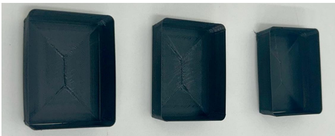
Figura 73 – Moldes para os corpos de prova para DRX impressos em ABS.
