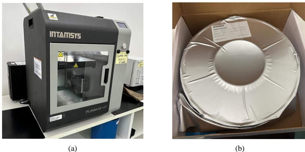
Figura 32- (a) Impressora FUNMAT HT; (b) Filamento INTAMSYS®PEEK.
