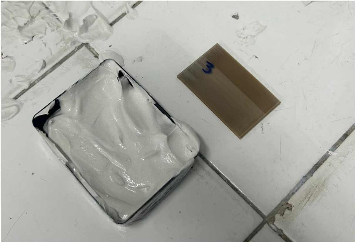
Figura 43 – Moldes de ABS com primeira camada de gesso.
