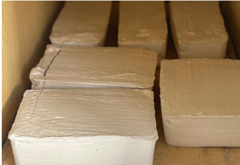
Figura 48 - Moldes de gesso dispostos no forno mufla.
