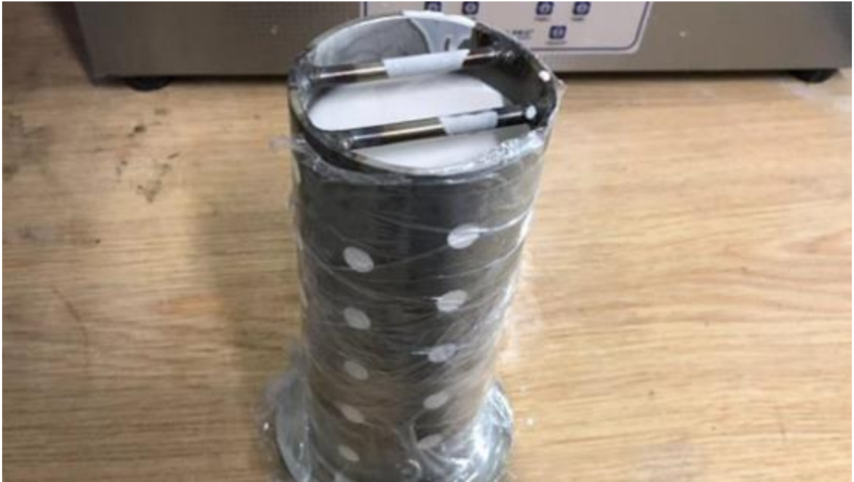
Figura 6 - Molde de vazamento com a suspensão de gesso.
