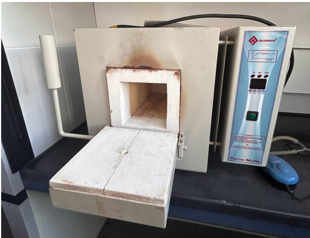
Figura 46 - Forno mufla utilizado no tratamento térmico.
