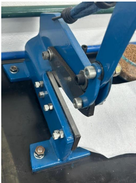
Figura 55– (a) Guilhotina utilizada; (b) Amostras cortadas e separadas.
