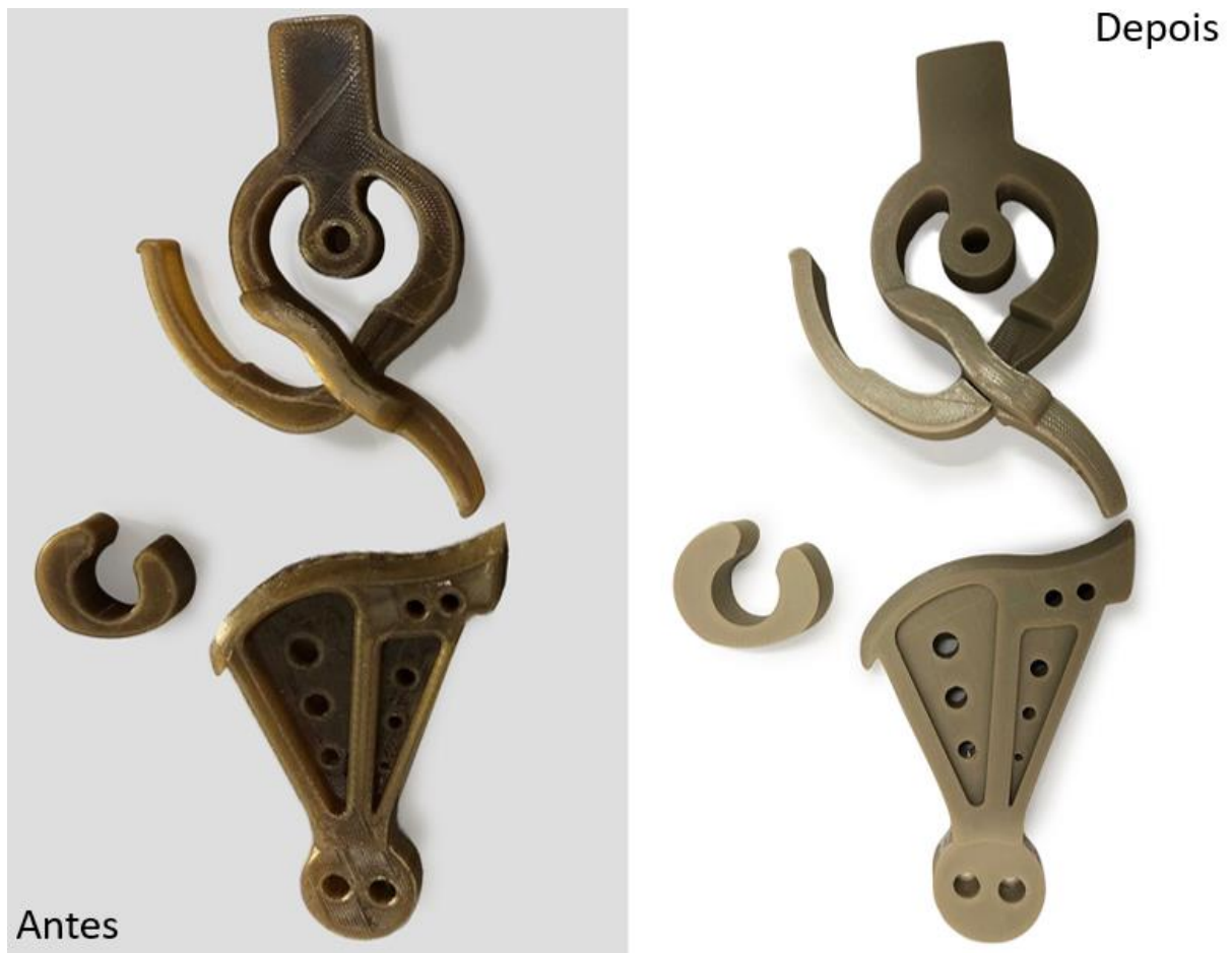
Figura 9 - Imagem comparativa das peças impressas em INTAMSYS®PEEK, antes e após o tratamento térmico.
