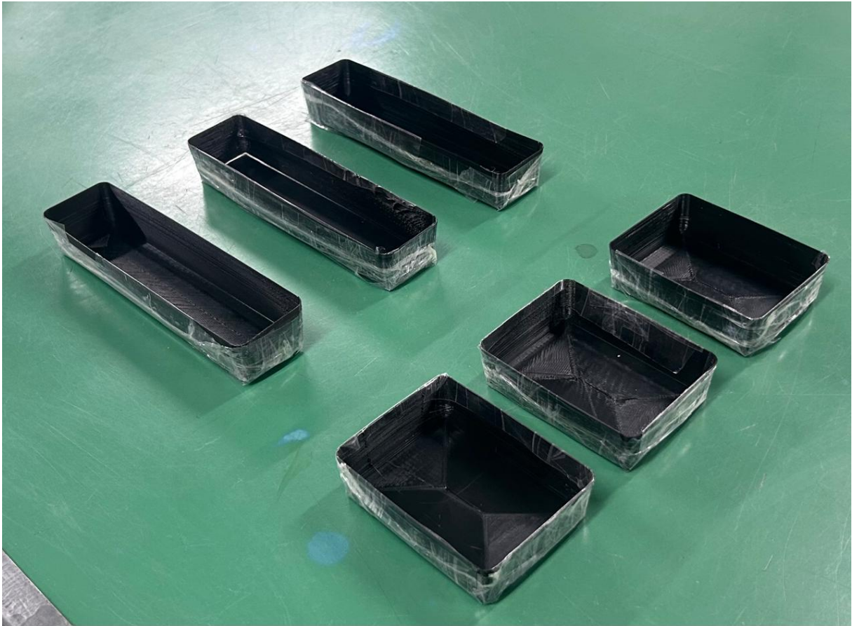
Figura 42 – Moldes de ABS envoltos de plástico filme.
