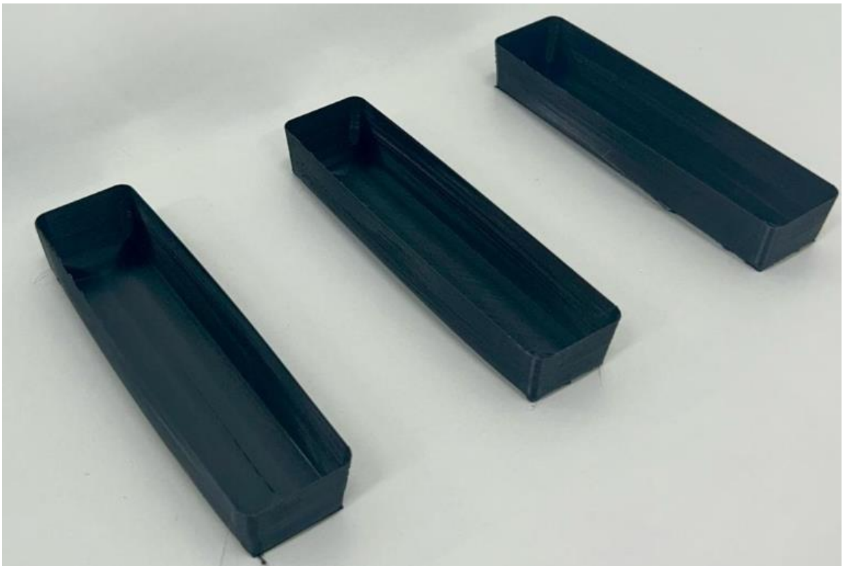
Figura 70 – Moldes para os corpos de prova de flexão impressos em ABS.
