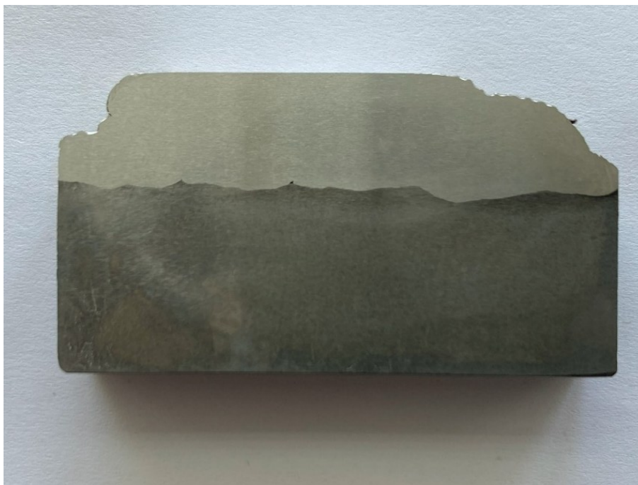
Figura 67: Macrografia da seção transversal - liga padrão
