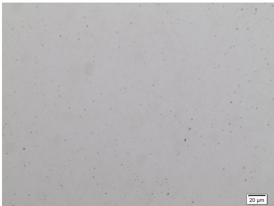
Figura 86: Micrografia ótica do topo do metal depositados antes do ataque eletrolítico – Amostra P1
