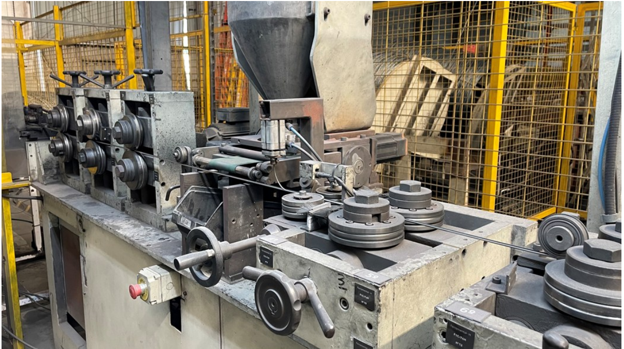
Figura 6: Maquinário de laminação e trefilação de arame tubular: destaque dos rolos de laminação e de fechamento do tubo em “U”.
