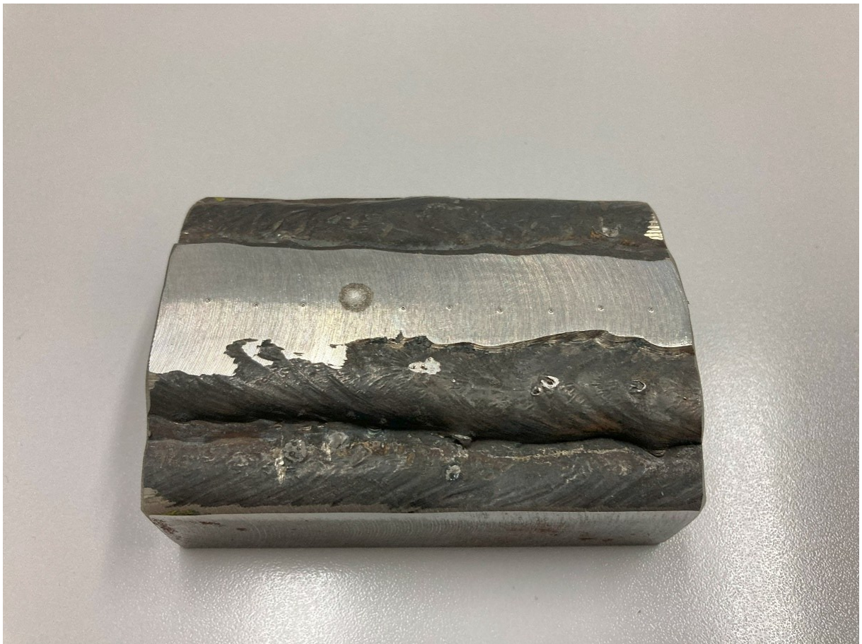
Figura 51: Corpo de prova referente à Proposta 8 após usinagem e corte da chapa de aço revestida com os cordões de solda
