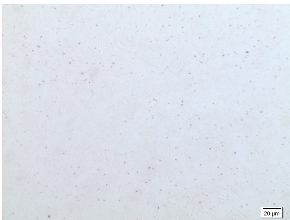
Figura 87: Micrografia ótica do topo do metal depositados antes do ataque eletrolítico – Amostra P2
