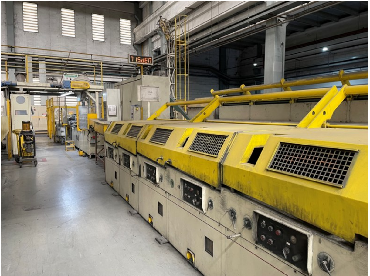
Figura 4: Maquinário de laminação e trefilação de arame tubular: visão geral da linha de produção
