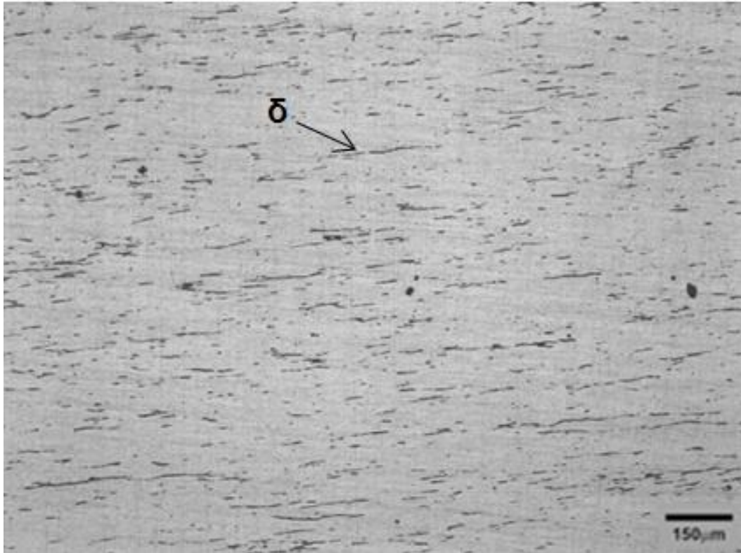
Figura 16: Microscopia ótica revelando ferrita \delta em aço SMSS laminado à quente. Ataque eletrolítico com eletrólito contendo 20%NaOH (Passante, et al., 2014)
