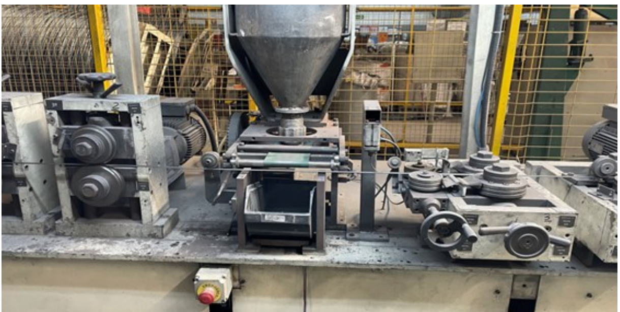
Figura 5: Maquinário de laminação e trefilação de arame tubular: destaque do reservatório e ponto de queda do fluxo
