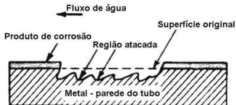
Figura 3.6.1: Corrosão-erosão em um tubo.<sup>78</sup>
