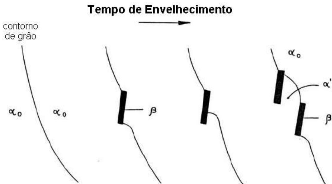
Figura 3.1.7: Mecanismo para a iniciação da precipitação descontínua a partir de um contorno de grão inicialmente ocupado.<sup>28</sup>
